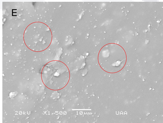
Ilustración 14 Microfotografía (1500X) de un andamio de 15% b-TCP y 85% PLA.
