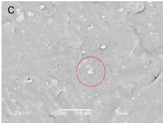
Ilustración 15 Microfotografía (500X) de un andamio de 20% b-TCP y 80% PLA.
