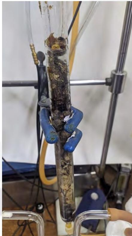
**Figura 6. Sistema de evaluación de la toxicidad del efluente gaseoso en la biodegradación del tolueno por *Macrophomina phaseolina*.**
