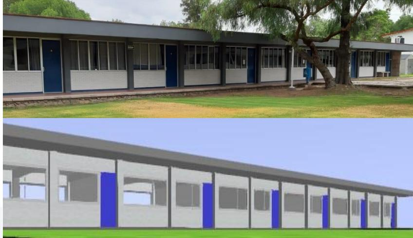
*Figura 2. Modelo Edificio 43 Universidad Autónoma de Aguascalientes. Generado en DIALux evo 9.0. Elaborado por el autor.*
