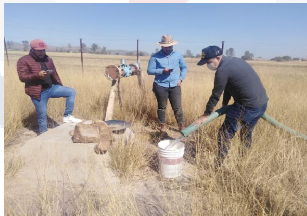
Ilustración 13. Llenado de la cubeta para calcular el caudal de vaciado.
