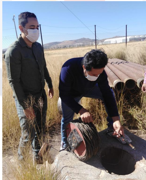
Ilustración 9. Sonda para medir la profundidad del nivel de agua dentro del pozo.
