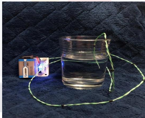
Ilustración 19. Demostración del funcionamiento del circuito eléctrico al entrar en contacto con el agua.
