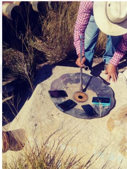
Ilustración 7. Dispositivos utilizados para grabar el sonido producido dentro del pozo.
