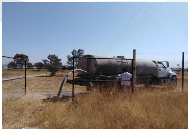
Ilustración 12. Pipa de agua con capacidad de 10000 litros de agua.
