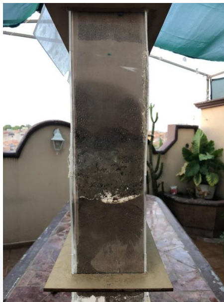
Ilustración 21. Apertura del molde debido a la presión del agua y del material.
