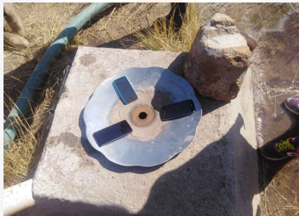
Ilustración 15. Grabación del sonido producido dentro del pozo por medio de dispositivos de sonido.
