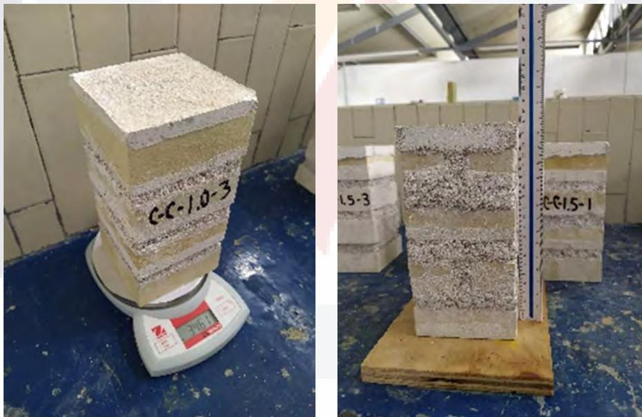
Figura 19 Pesado y medido de probetas, autoría propia.
