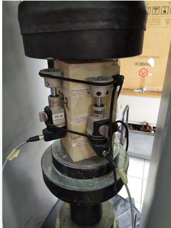
Figura 21 Probeta sobre la prensa universal con deformímetros instalados, autoría propia.
