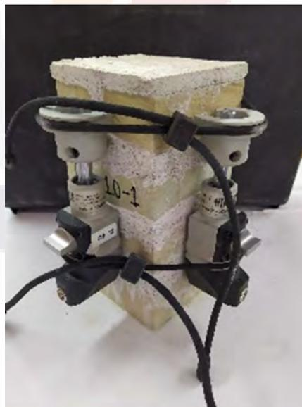
Figura 7 Deformímetros digitales instalados, autoría propia.
