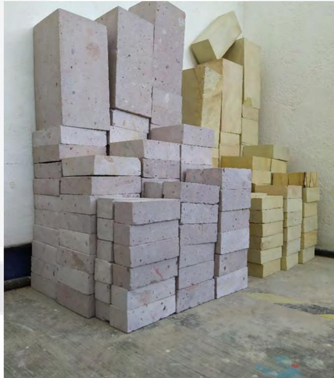
Figura 13 Mampuestos cortados para las probetas, autoría propia.
