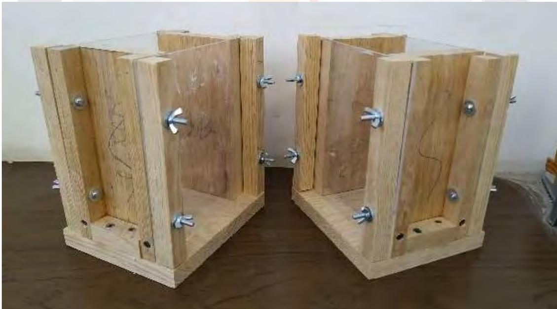
Figura 12 Moldes fabricados para la elaboración de las probetas, autoría propia.
