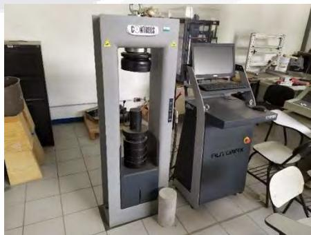
Figura 8 Prensa universal de la marca CONTROLS modelo 70-S12Z00, autoría propia.
