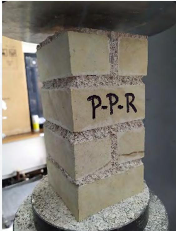
Figura 20 Obtención de la resistencia a la compresión, autoría propia.
