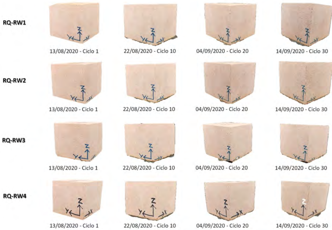
Figura 52. Ciclos de saturación- desecación con muestras de cantera roja en agua de lluvia. Elaboración propia.
