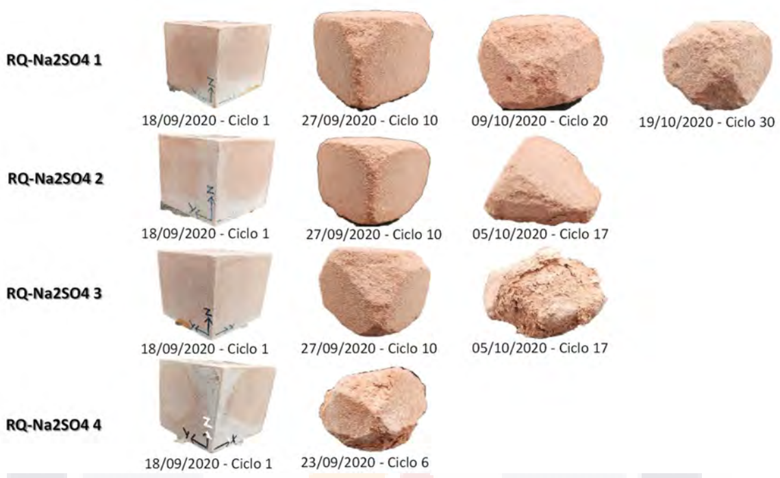
Figura 70. Ciclos de saturación- desecación con agua saturada de Na 2 SO 4 en muestras de cantera roja. Elaboración propia.
