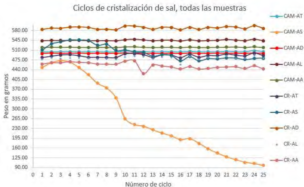
Figura 23. Cambios en el peso en gramos de las muestras sometidas a los procesos de saturación y desecación de pruebas piloto. Elaboración propia.
