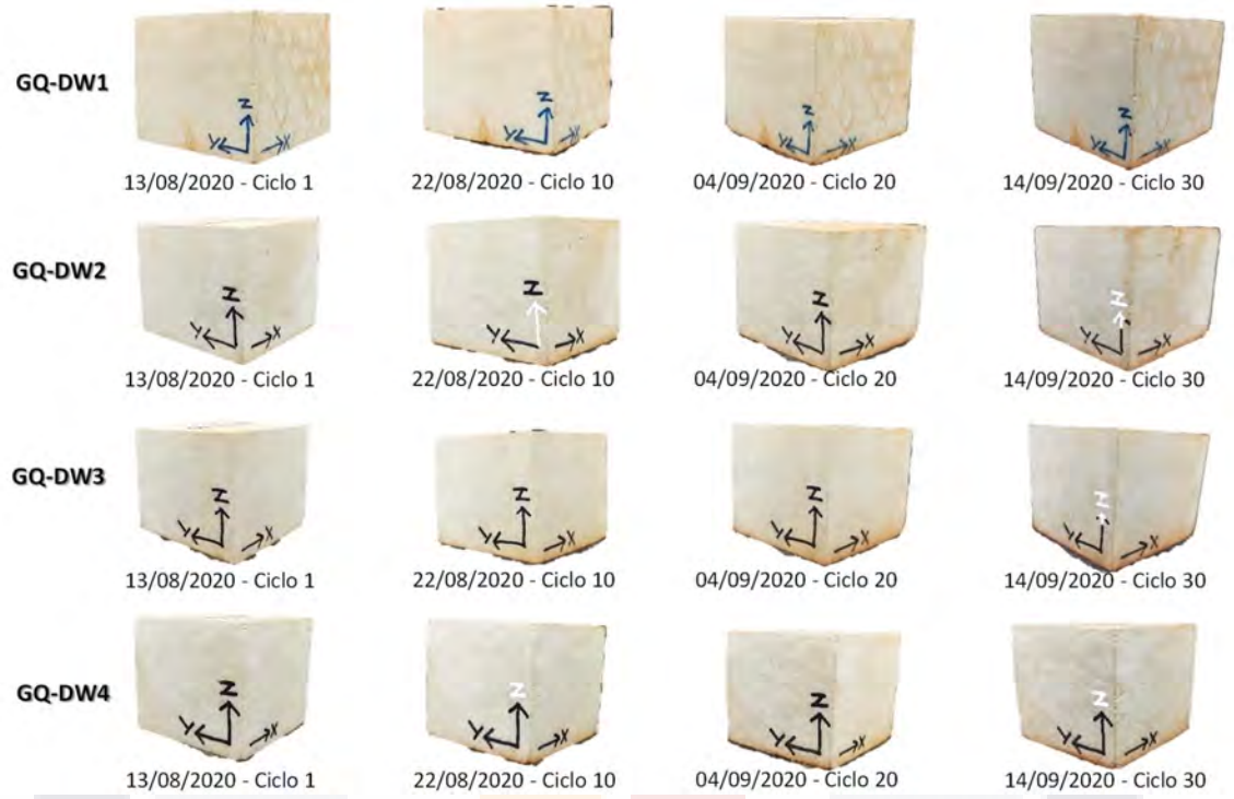
Figura 44. Ciclos de saturación- desecación con muestras de cantera verde en agua destilada. Elaboración propia.
