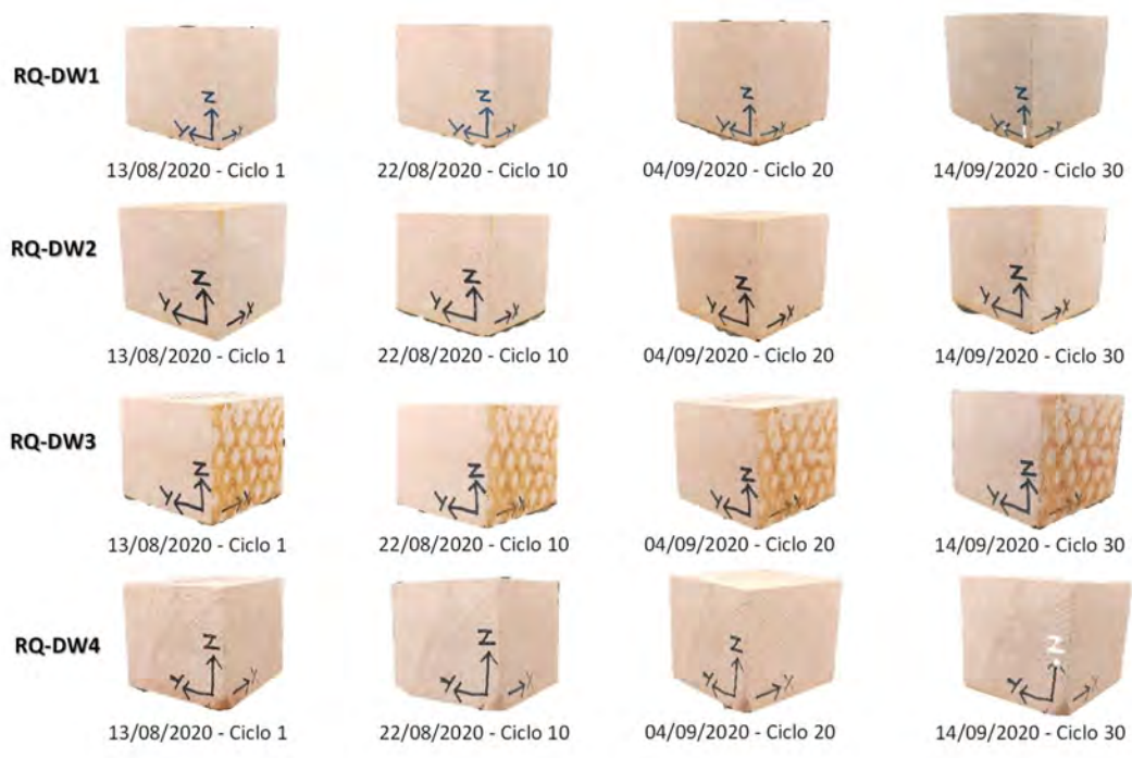
Figura 46. Ciclos de saturación- desecación con muestras de cantera roja en agua destilada. Elaboración propia.
