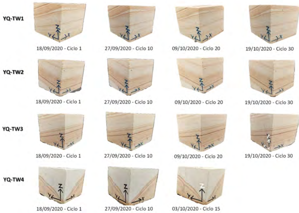
Figura 60. Ciclos de saturación- desecación con muestras de cantera amarilla en agua tratada. Elaboración propia.
