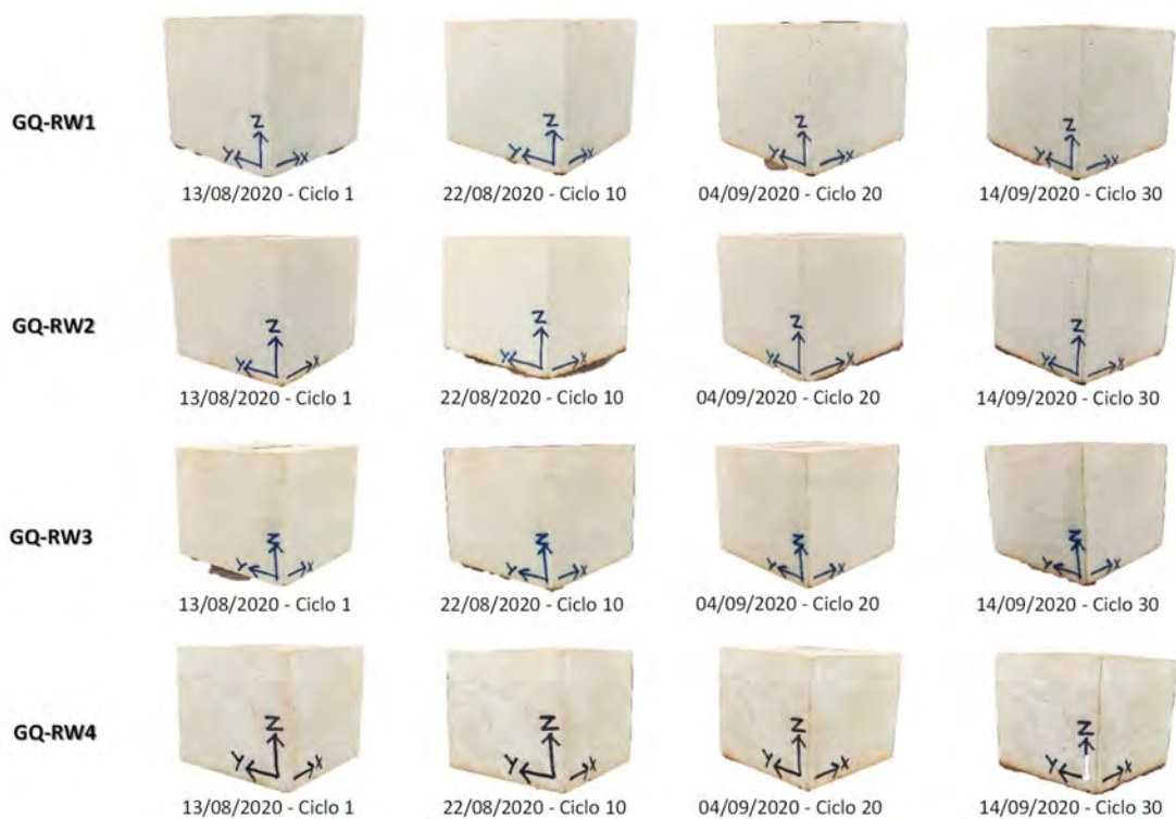
Figura 50. Ciclos de saturación- desecación con muestras de cantera verde en agua de lluvia. Elaboración propia.
