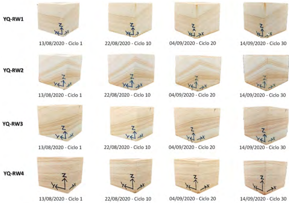
Figura 48. Ciclos de saturación- desecación con muestras de cantera amarilla en agua de lluvia. Elaboración propia.
