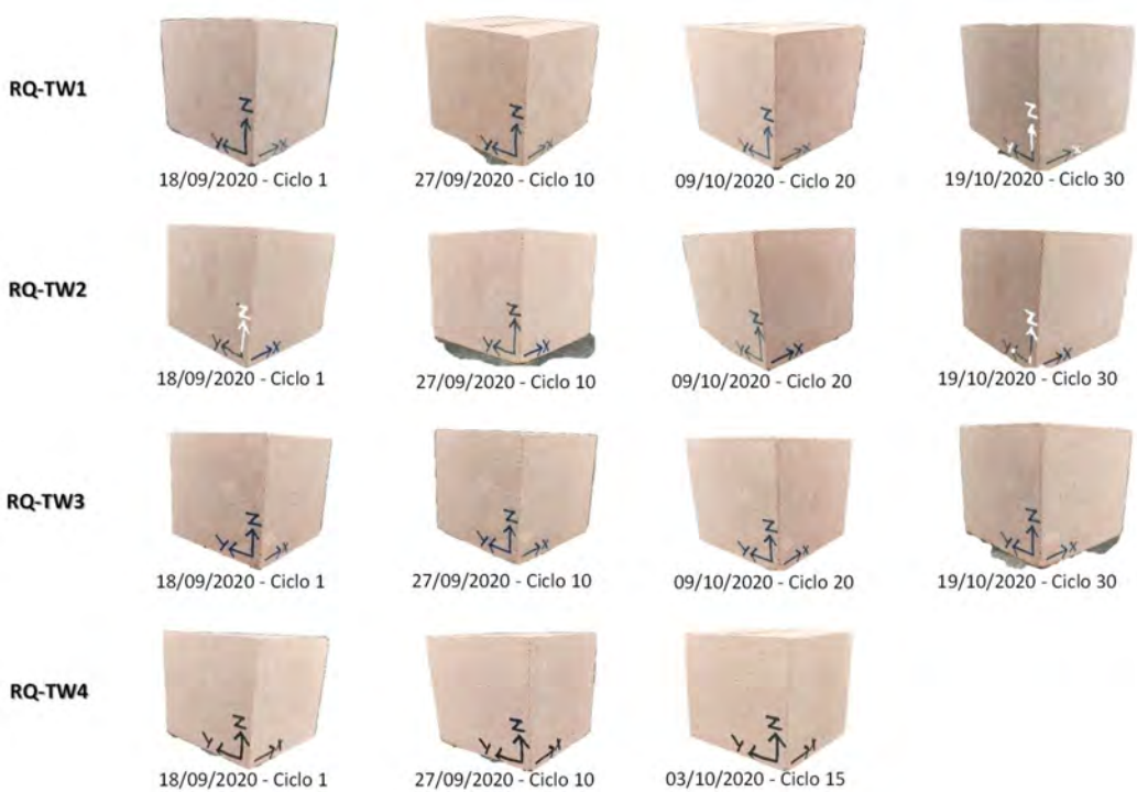
Figura 64. Ciclos de saturación- desecación con muestras de cantera roja en agua tratada. Elaboración propia.
