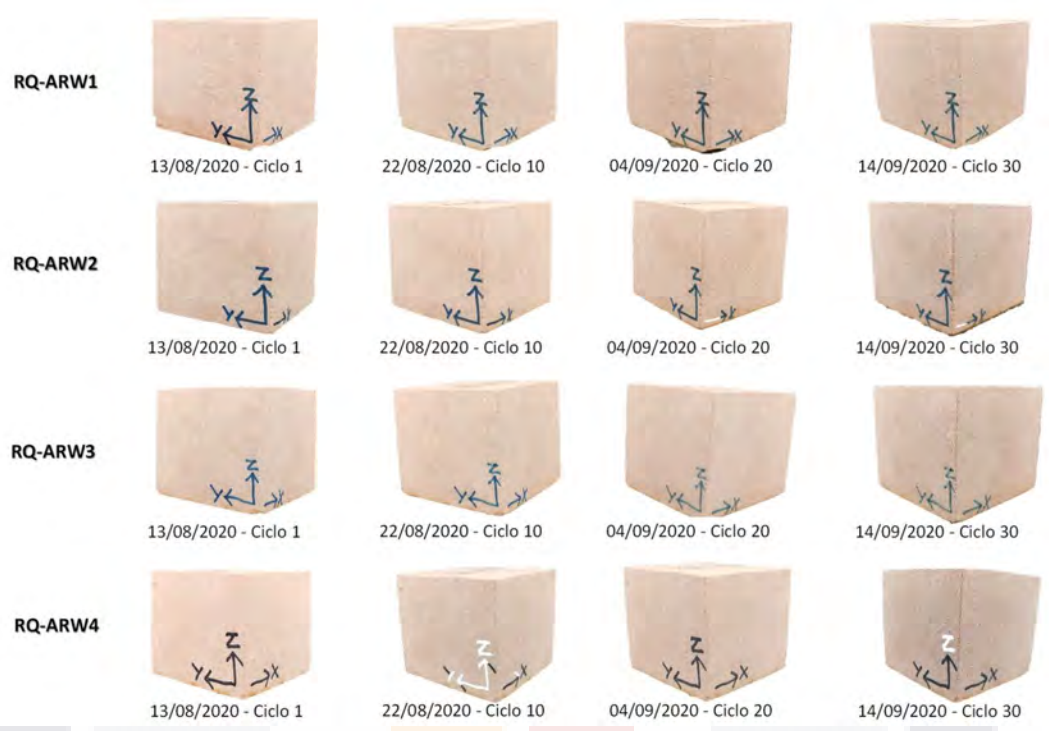
Figura 58. Ciclos de saturación- desecación con muestras de cantera roja en agua lluvia ácida. Elaboración propia.
