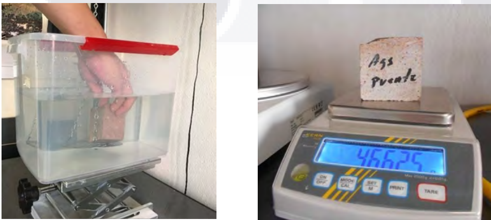
Figura 17. Obtención de peso seco (der.) y peso sumergido (izq.). Elaboración propia.
