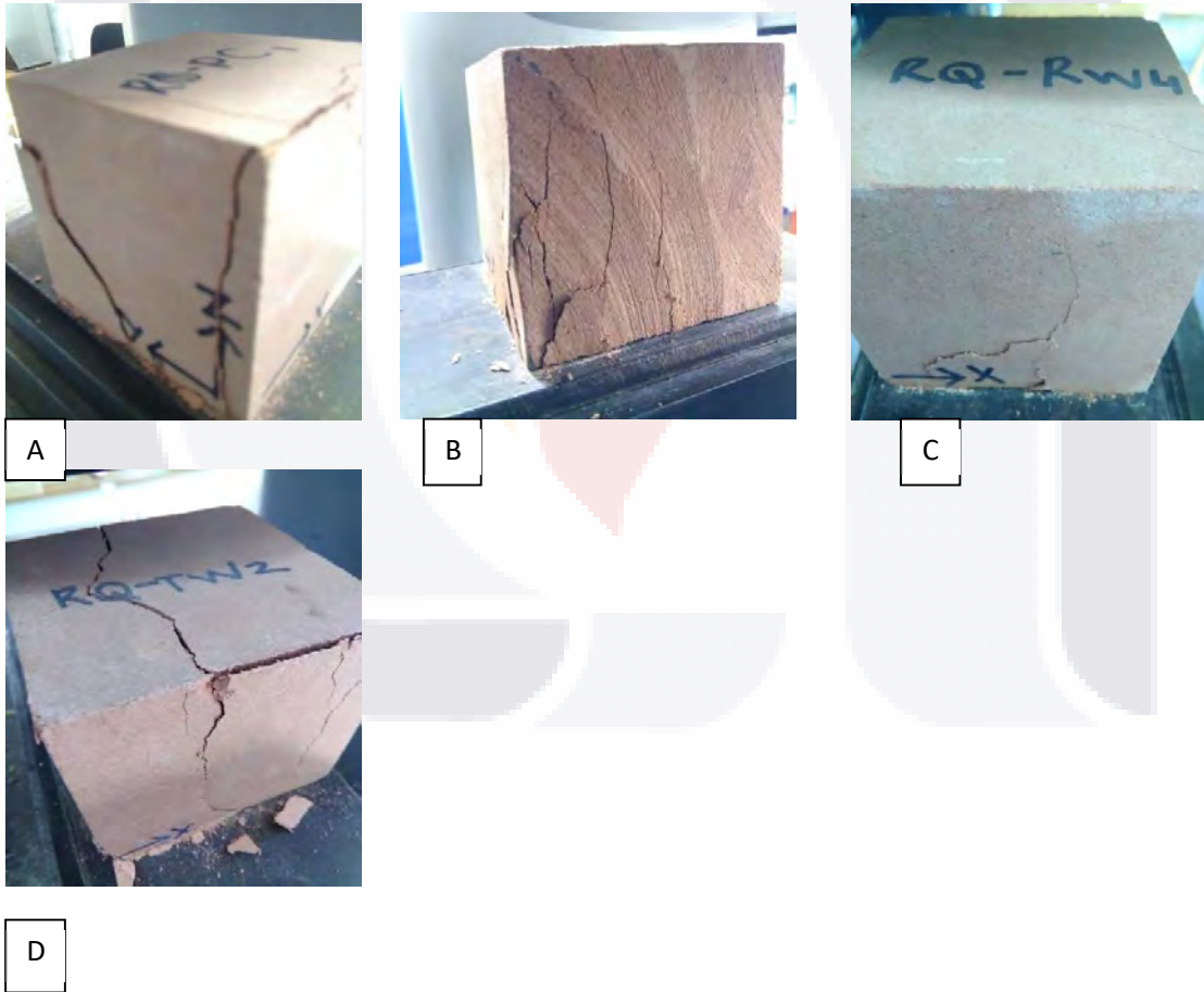
Figura 40. Muestras cantera roja sometidas a ensayo de compresión uniaxial A. Muestra Inalterada, B. Muestra sometida Agua Destilada, C. Muestra sometida Agua Lluvia, D. Muestra sometida Agua Tratada. Elaboración propia.
