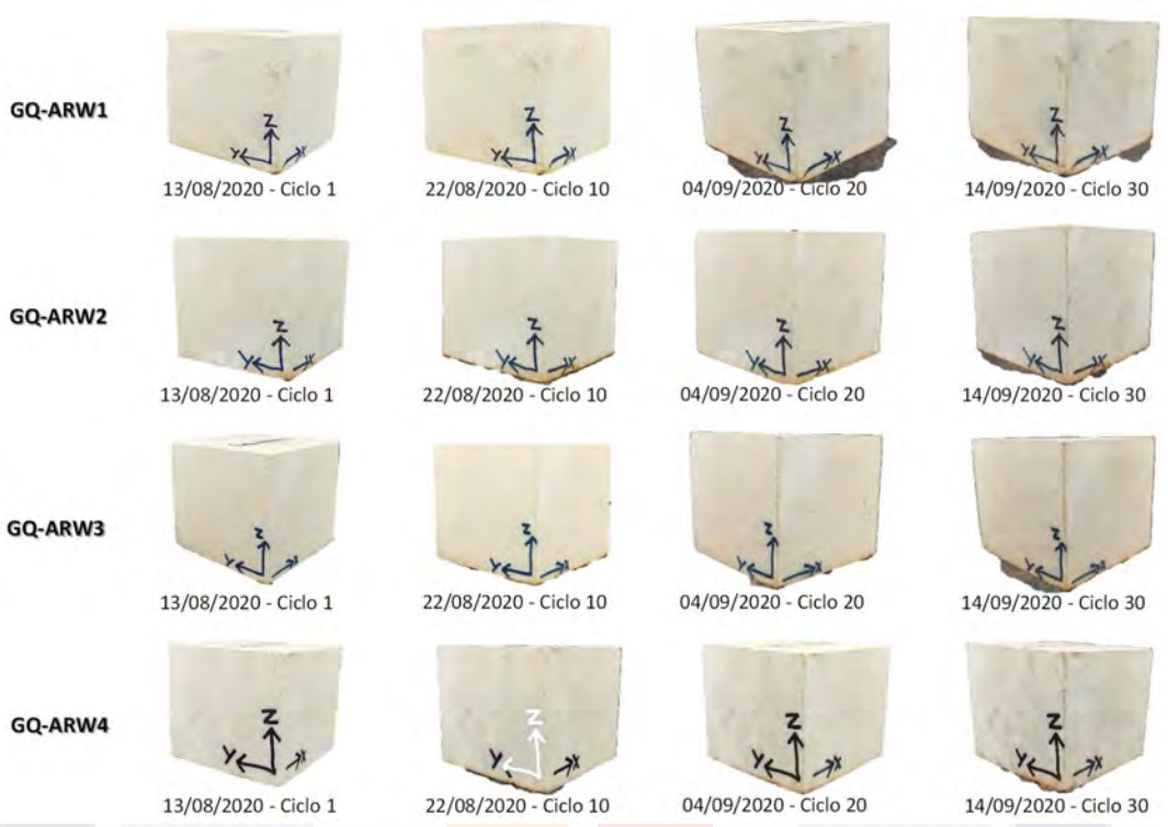
Figura 56. Ciclos de saturación- desecación con muestras de cantera verde en agua lluvia ácida. Elaboración propia.
