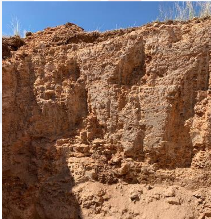
Figura 20: Excavación de Zanja para casa habitación considerada como afloramiento que cuenta con un sedimento detrítico inmediatamente posterior a la capa vegetal de suelo.
