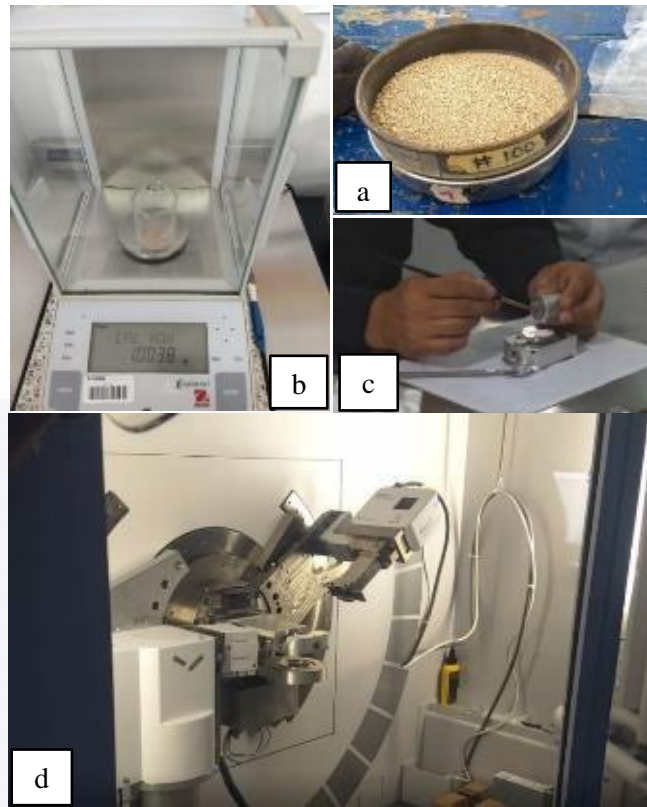
Figura 9: Collage de fotografías donde: a) Selección del material en polvo mediante el tamiz del No. 100 b) Balanza granataria de precisión c) Material para la elaboración de pastillas para el análisis de difracción de rayos X. d) Análisis de las fases minerales mediante el Empyrean II .
