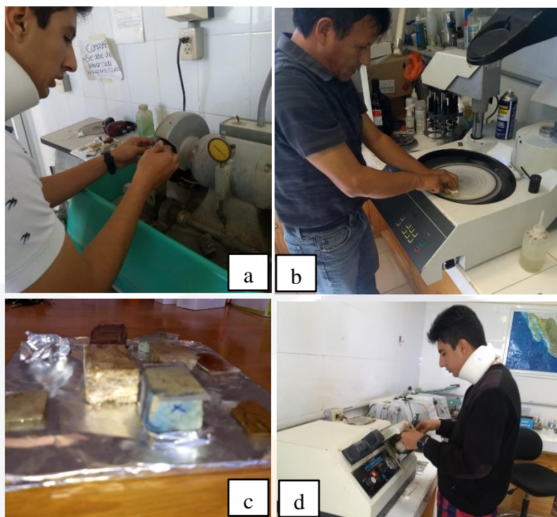
Figura 8: Collage de fotografías dónde se muestra: a) Cortado de las muestras de suelo mediante una cortadora con disco fino, b) Pulido de las muestras de suelo con la finalidad de obtener una cara lisa que se pegó en los portaobjetos c) Muestras colocadas en los portaobjetos mediante pegamento especial, d) Desbaste de las secciones delgadas mediante el uso de la pulidora petro thin buehler .
