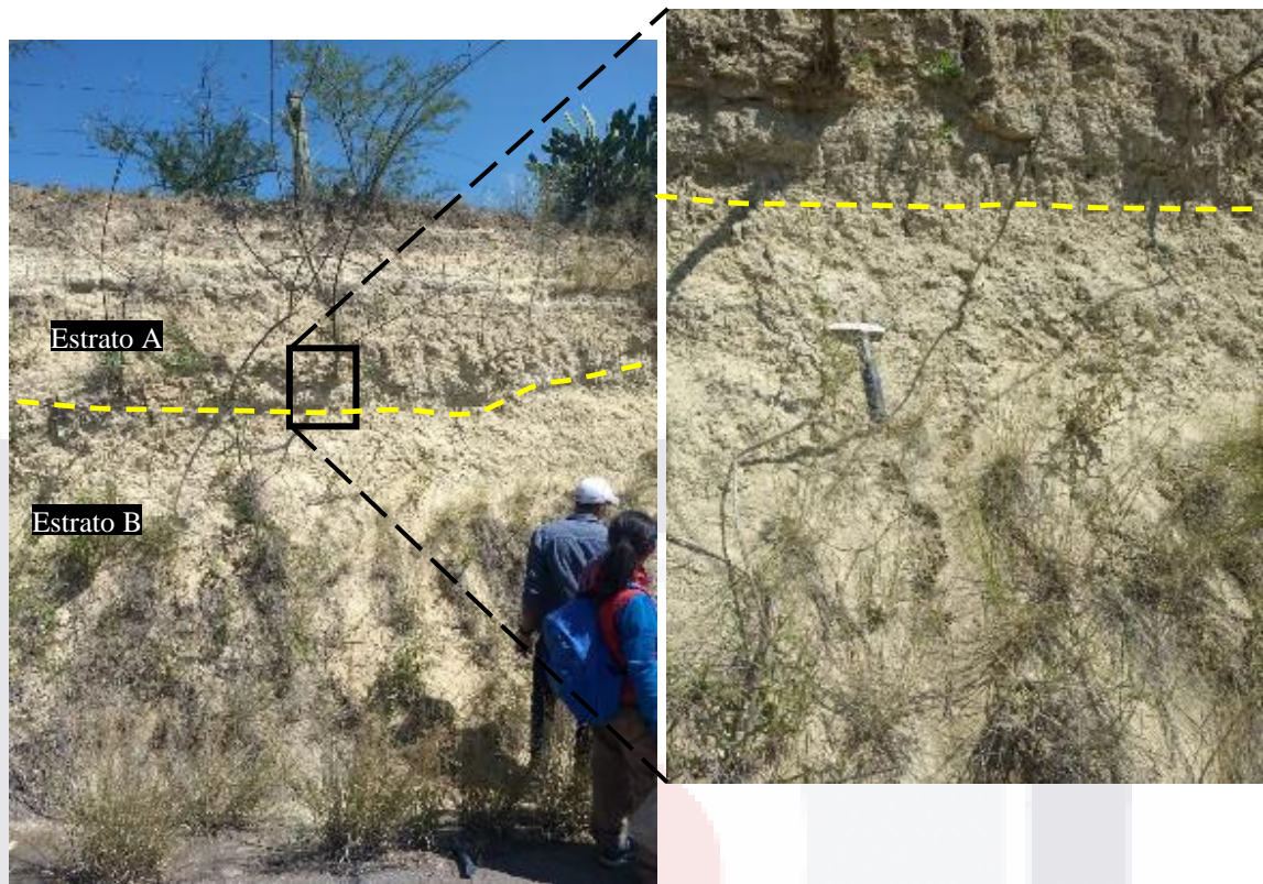
Figura 32: Estrato que se observa con una intemperización considerable, así como un contacto erosional.
