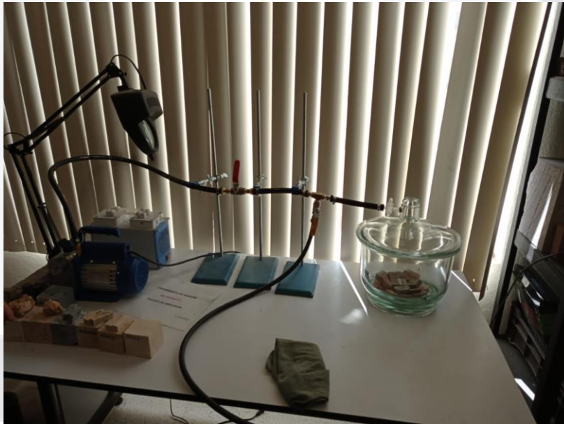
Figura 10: Bomba de extracción y campana de desecación para la extracción del aire de la muestra y absorción de agua al vacío.
