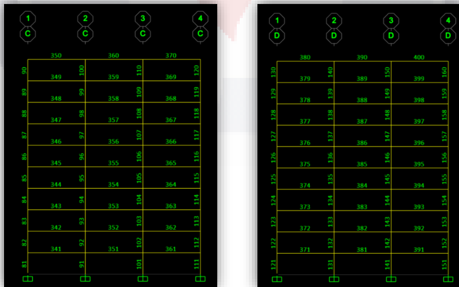
Ilustración 45. Marcos estructurales en los ejes "C" y "D".
