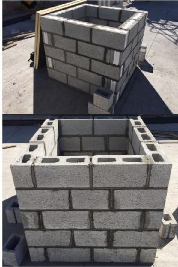
Ilustración 5. Módulos de Isoblock y Block de concreto convencional. Fuente (Herrera, 2017)
