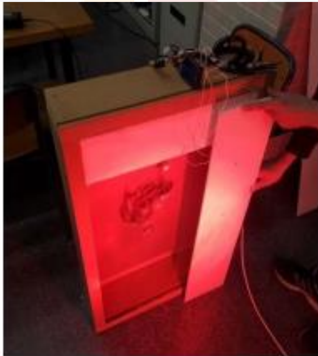
Ilustración 6. Propuesta experimental para el análisis de radiación en muros, empleando luz infrarroja. Fuente (Ellesser, 2019)
