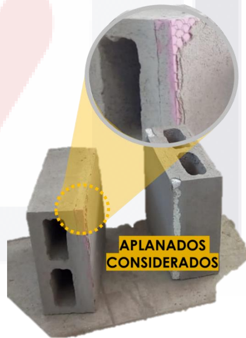
Ilustración 26. Muestras de block con recubrimientos aplicados. . Fuente: autoría propia
