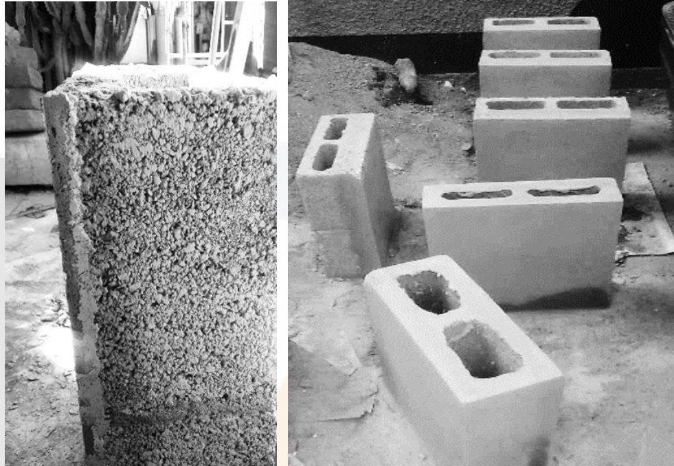
Ilustración 24. Construcción de especímenes sin recubrimiento térmico. . Fuente: autoría propia
