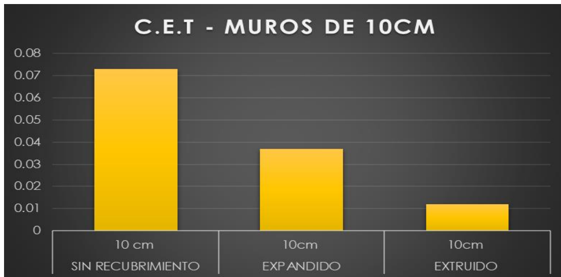
Ilustración 38 Resultados C.e.t. en muros de 10 cm – pruebas experimentales
