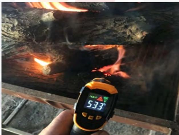
*Fig. 15. Medición de temperatura de combustión de madera en la envolvente del fuego. (Elaboración propia)*
