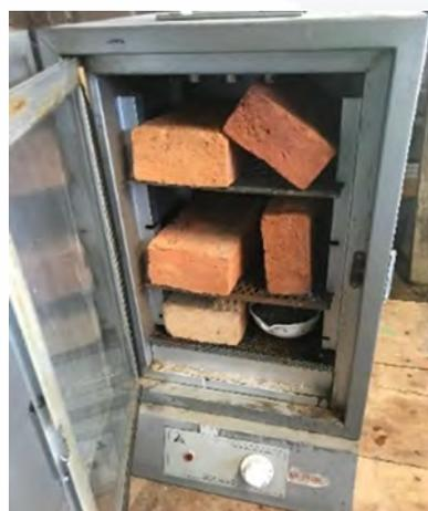
Fig. 54. Tabiques dispuestos para sacado a 24 horas para tener peso completamente seco. (Elaboración propia)
