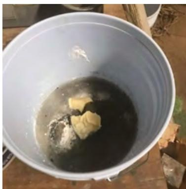
Fig. 38. Mezcla con 30% de ceniza en sustitución de la cal. Escurrecimiento de agua y mucílago de nopal. (Elaboración propia)
