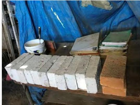
Fig. 67. Probetas para revisión de adherencia. (Elaboración propia)
