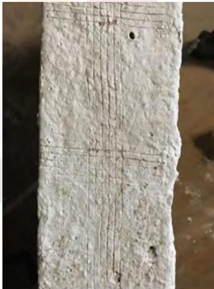
*Fig. 72. Resultado de corte en cruz, sobre superficie de análisis de adherencia. (Elaboración propia)*
