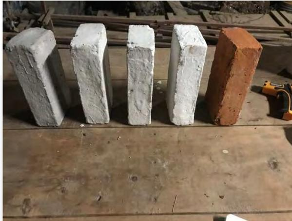
Fig. 73. Probetas con manto aplicado para medir la transpiración. (Elaboración propia)
