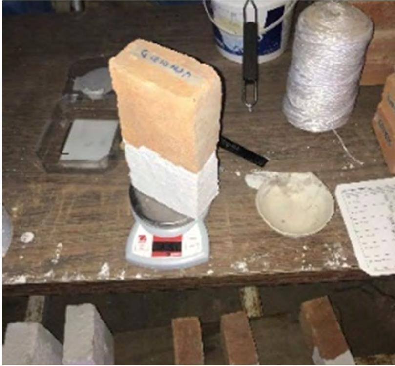
Fig. 56. Obtención de peso seco con impermeabilizante aplicado. (Elaboración propia)
