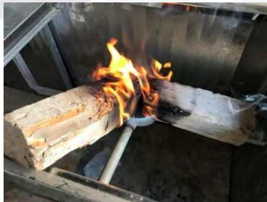
*Fig. 8. Combustión de polines a fuego directo para obtención de cenizas. (Elaboración propia)*
