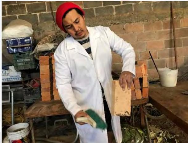
*Fig. 52. Preparación de la muestra para aplicación de mezcla, mediante limpieza de impurezas y material adicional a la probeta. (Elaboración propia)*
