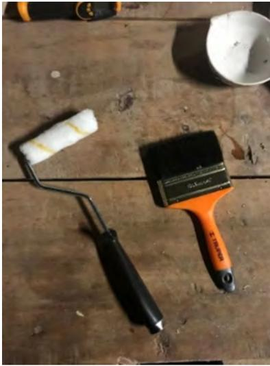
Fig. 44. Herramienta utilizada para la aplicación de mezclas impermeabilizantes en probetas. Ecurrimiento de agua y mucilago de nopal. (Elaboración propia)
