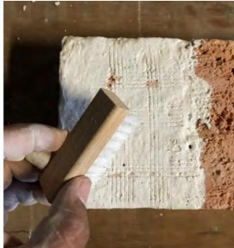
*Fig. 71. Limpieza de la superficie cortada para observación de desprendimiento. (Elaboración propia)*
