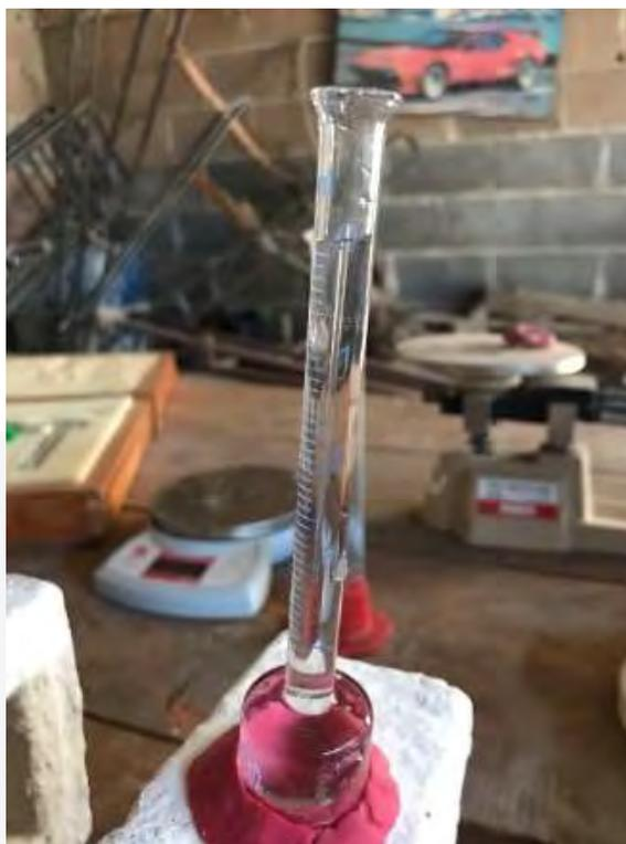
Fig. 61. Observación de graduación y enrase de líquido en tubo de Karsten. (Elaboración propia)
