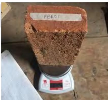
Fig. 55. Pesado de probetas completamente secas. (Elaboración propia)
