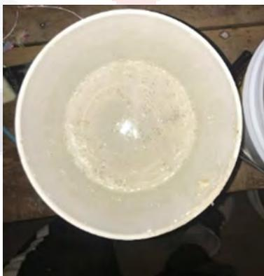
Fig. 40. Resultado de mezcla con 5% de ceniza. Escurrecimiento de agua y mucílago de nopal. (Elaboración propia)
