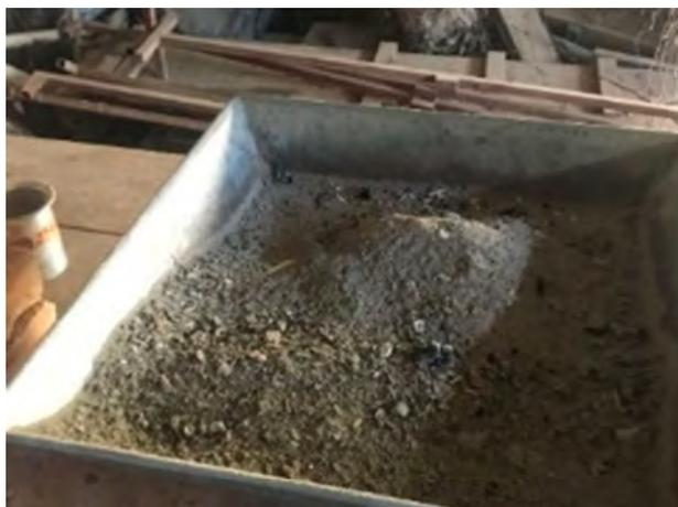
Fig. 20. Concentrado de cenizas de criba. (Elaboración propia)
