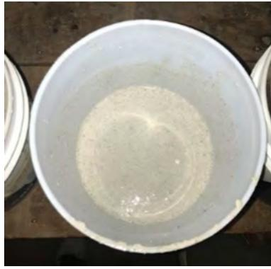
Fig. 41. Resultado de mezcla con 10% de ceniza. Escurrimiento de agua y mucílago de nopal. (Elaboración propia)
