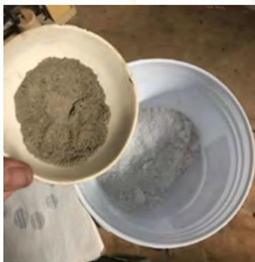
Fig. 36. Adición de cenizas a mezclas. Esgurrimento de agua y mucílago de nopal. (Elaboración propia)
