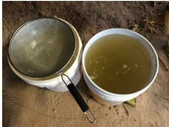
Fig. 30. Solución de Agua-mucilago para mezcla. Ecurrimiento de agua y mucílago de nopal. (Elaboración propia)
