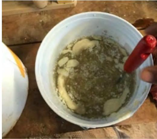
*Fig. 33. Mezclado de componentes de mezcla base. Ecurrimiento de agua y mucílago de nopal. (Elaboración propia)*
