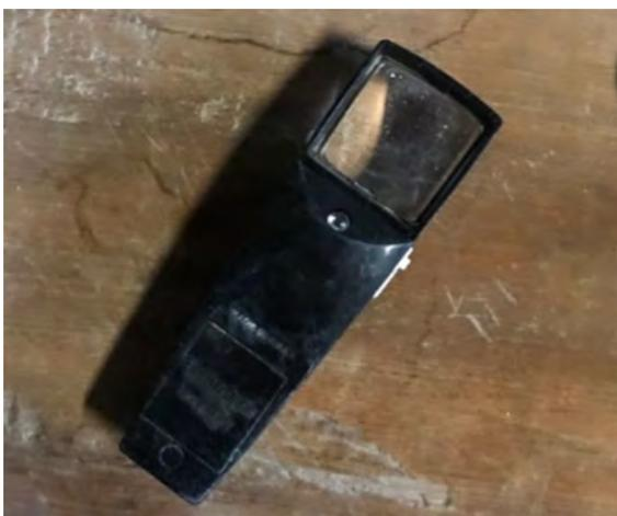
Fig. 64. Lupa para observación de desprendimientos. (Elaboración propia)
