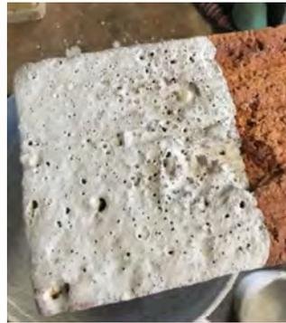
*Fig. 51. Muestra con porosidad excesiva la cual requirió hasta 4 manos para el sellado completo de la superficie. (Elaboración propia)*
