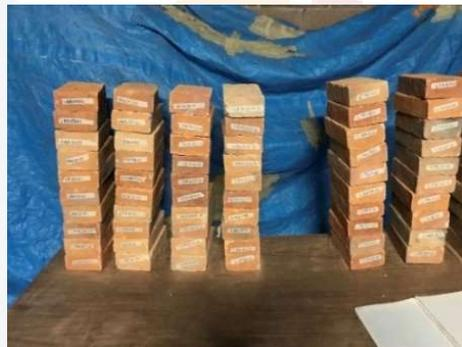
Fig. 45. Identificación de probetas para aplicación de mezclas y posterior realización de pruebas específicas. Ecurrimiento de agua y mucilago de nopal. (Elaboración propia)
