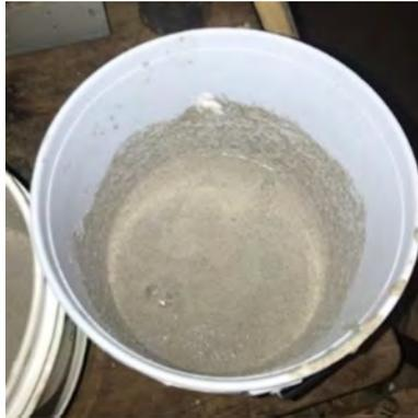
Fig. 42. Resultado de mezcla con 30% de ceniza. Escurrimiento de agua y mucílago de nopal. (Elaboración propia)
