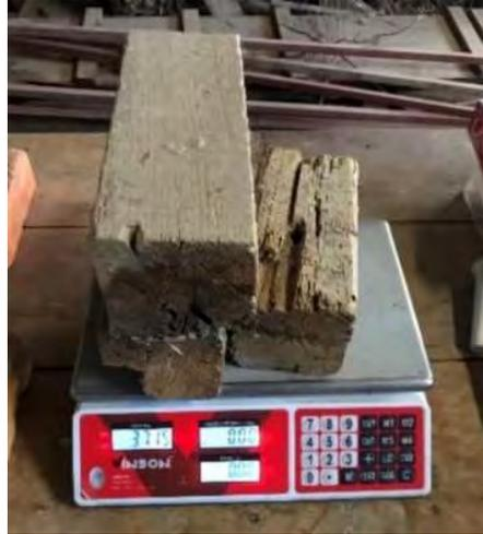
*Fig. 7. Obtención de peso de madera en desuso para análisis de rendimiento de ceniza. (Elaboración propia)*
