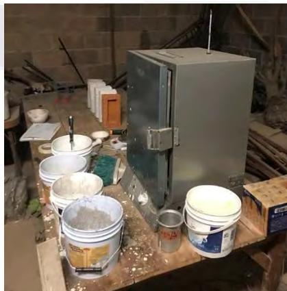
Fig. 43. Mezclas de impermeabilizante con distinta dosificación para aplicación. Escurrimiento de agua y mucílago de nopal. (Elaboración propia)
