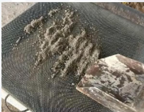
Fig. 21. Cribado de cenizas para preparación de mezclado. (Elaboración propia)
