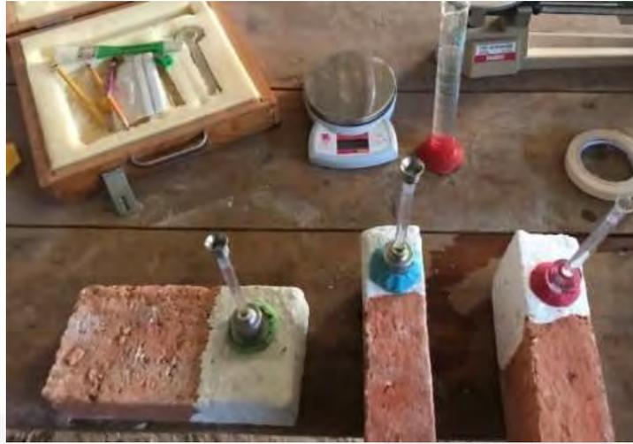
Fig. 59. Probetas sujetas a procedimiento de permeabilidad. (Elaboración propia)
