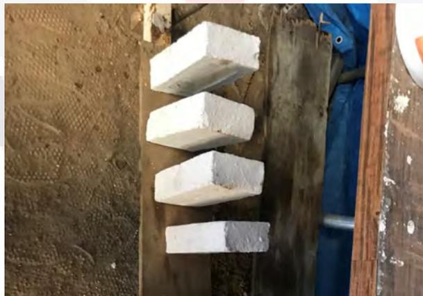
Fig. 74. Probetas en reposo a 24 hora de proceso de transpiración. (Elaboración propia)
