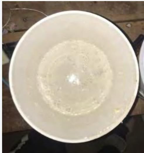
*Fig. 34. Dosificación de Mezcla Base disuelta para aplicación a probetas (Mezcla 01) Ecurrimiento de agua y mucílago de nopal. (Elaboración propia)*
