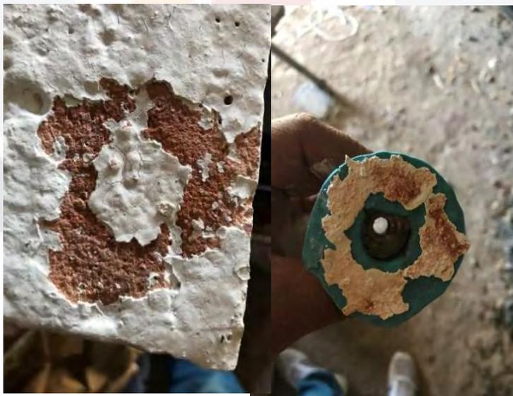
Fig. 62. Accidentes y desprendimientos de capa en la colocación de tubo de Karsten. (Elaboración propia)
