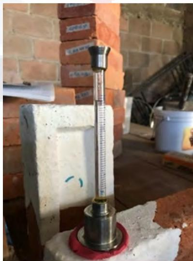
Fig. 60. Tubo de Karsten en probeta de análisis. (Elaboración propia)
