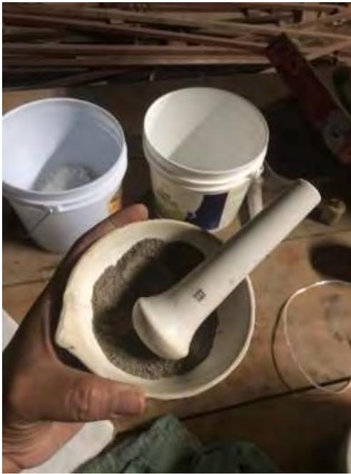
Fig. 23. Preparación de cenizas en mortero para pulverizar y mezclar. (Elaboración propia)
