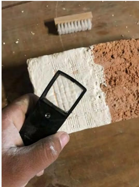
*Fig. 69. análisis con lupa del resultado de desprendimiento en superficie. (Elaboración propia)*
