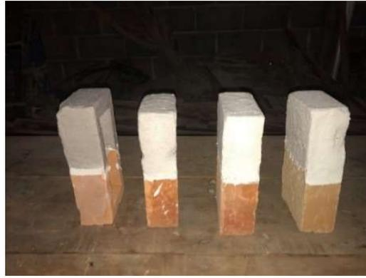
Fig. 47. Probetas con segunda mano aplicada de impermeabilizante. Ecurrimiento de agua y mucílago de nopal. (Elaboración propia)
