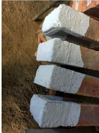
*Fig. 57. Probetas con superficie preparada para la colocación de tubos de Karsten y observación de permeabilidad. (Elaboración propia)*
