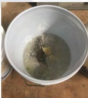
Fig. 37. Mezcla con 10% de ceniza. Esgurrimento de agua y mucílago de nopal. (Elaboración propia)
