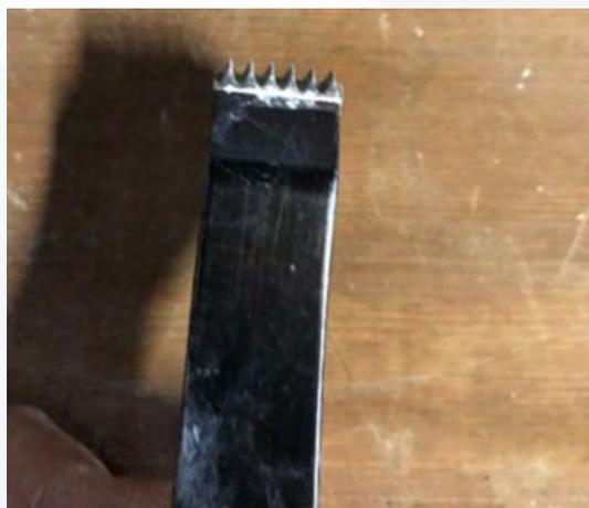
Fig. 65. Herramienta de corte para forjado de cruz y malla para análisis de desprendimiento sobre la norma ASTM. (Elaboración propia)
