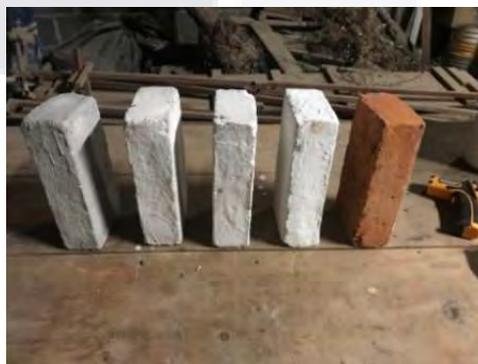
Fig. 46. Probetas con primer mano aplicada de impermeabilizante. Ecurrimiento de agua y mucilago de nopal. (Elaboración propia)
