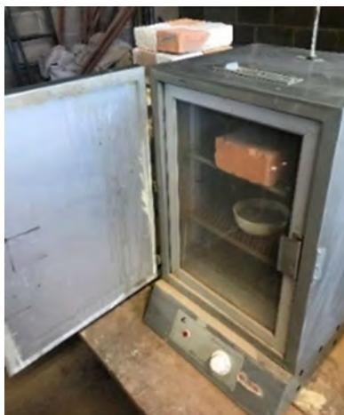
Fig. 53. Horno para secado de muestras. (Elaboración Propia)
