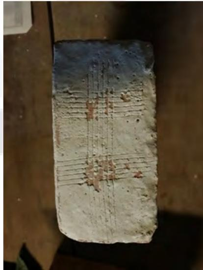
Fig. 68. Resultado de corte en superficie con alto índice de desprendimiento. (Elaboración propia)
