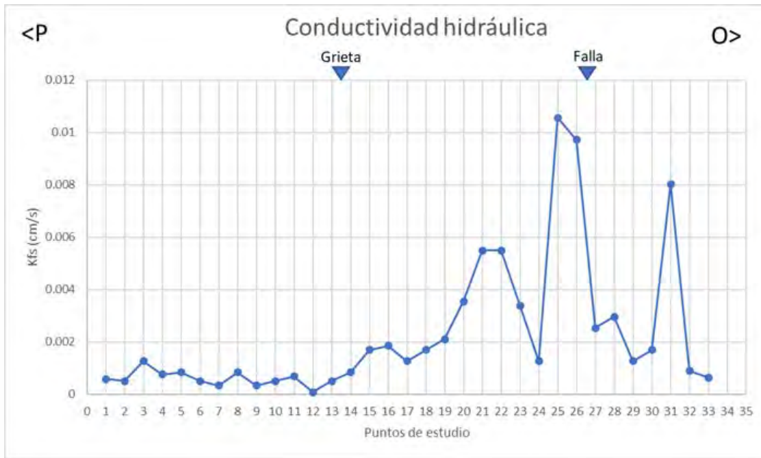
Figura 10. Perfil de variación de la conductividad hidráulica, obtenido de las pruebas de permeabilidad. La ubicación y orientación del perfil se muestra en la Figura 9.A.
