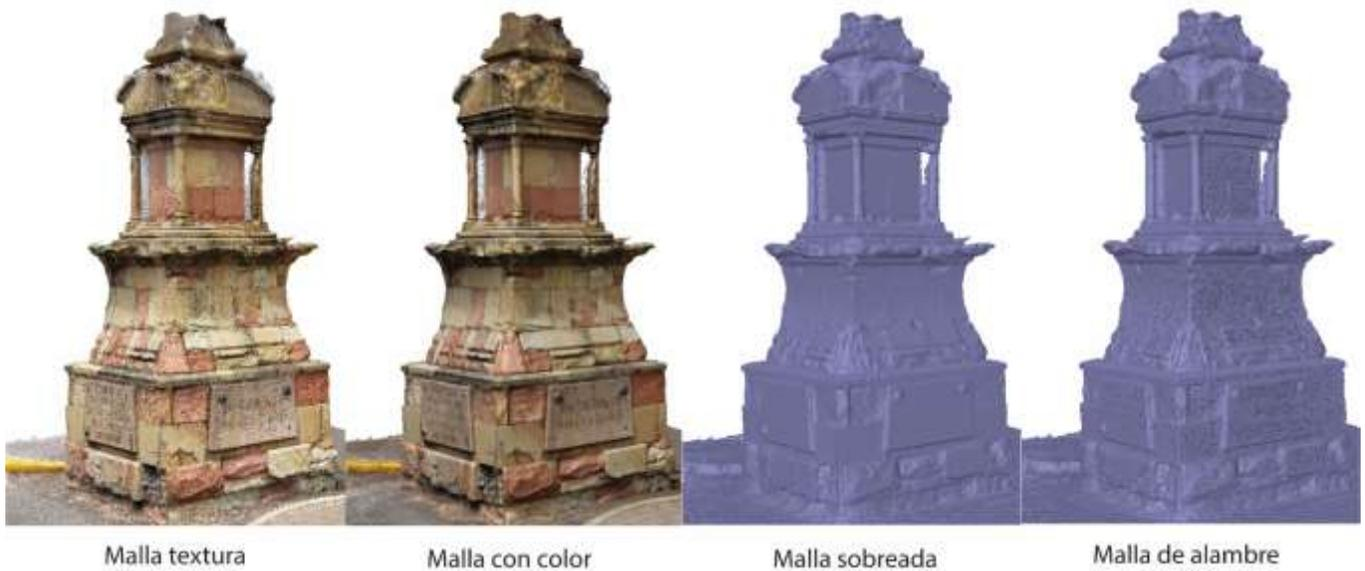
Ilustración 72 Creación de los diferentes tipos de malla. Elaboración propia
