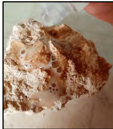
Figura 3. Efervescencia de un suelo carbonatado. Elaboración propia.
