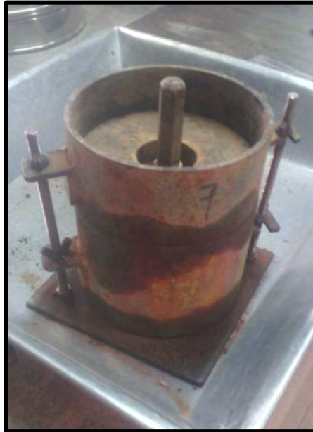
Figura 10. Colocación de placas de sobre carga en el espécimen. Elaboración propia.
