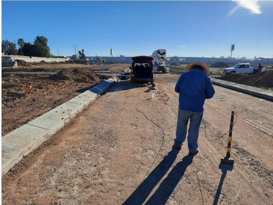
Figura 57. Medición en hombro izquierdo. Configuración: Separación de los geófonos @ 1m, disparo a 5m, alineados. Elaboración propia.
