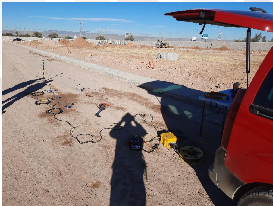
Figura 58. Medición en hombro izquierdo. Configuración: Separación de los geófonos @ 1m, disparo a 2m, perpendiculares. Elaboración propia.
