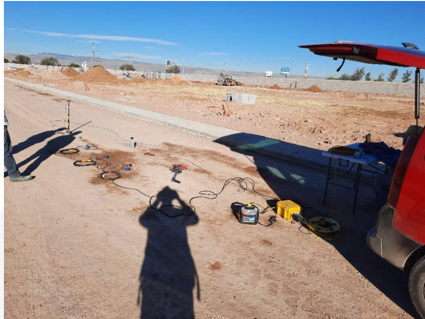
Figura 59. Medición en hombro izquierdo. Configuración: Separación de los geófonos @ 1m, disparo a 3m, perpendiculares. Elaboración propia.
