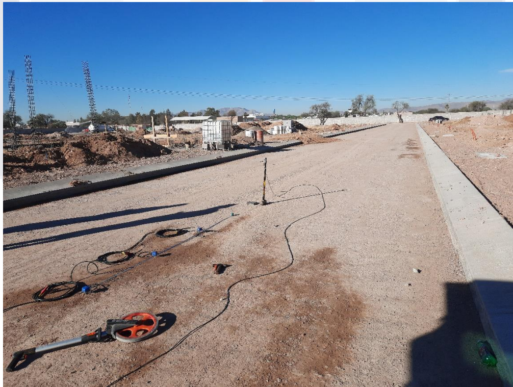
Figura 15. Acomodo de geófonos en zona de hombro izquierdo de la vialidad en el eje 14 del desarrollo urbano. Elaboración propia.
