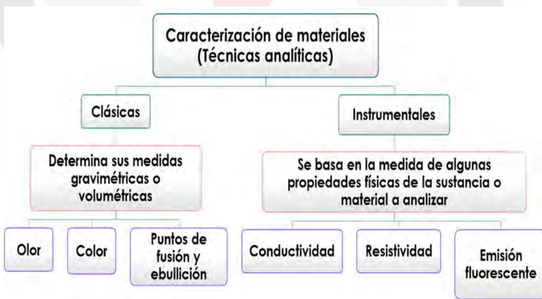
FIGURA 11 Clasificación de la caracterización de materiales Elaboración Propia basada en . (Skoog & Leary, 1996)
