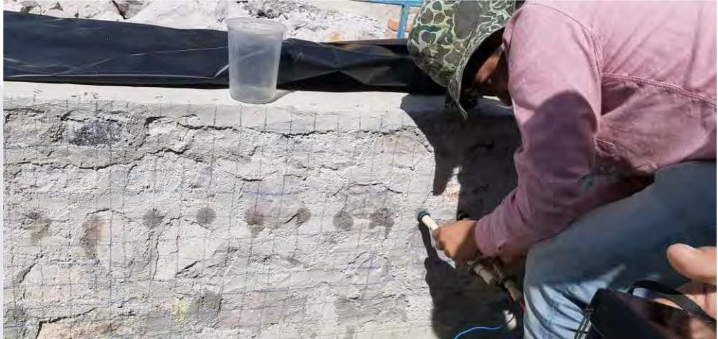
FIGURA 46 Aplicación de un sondeo manual con electrodos de CPVC.
