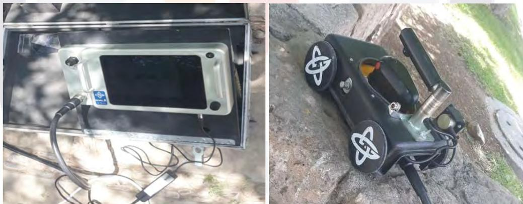
FIGURA 22 Antena de GPR y pantalla del equipo utilizado Elaboración Propia
