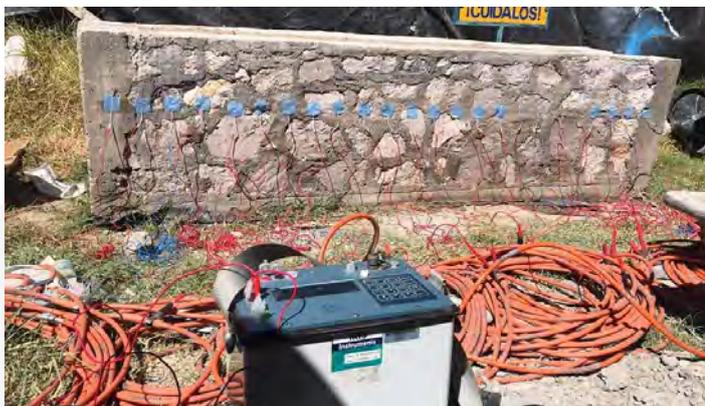
*FIGURA 38 Muro experimental con electrodos médicos colocados para sondeo*
