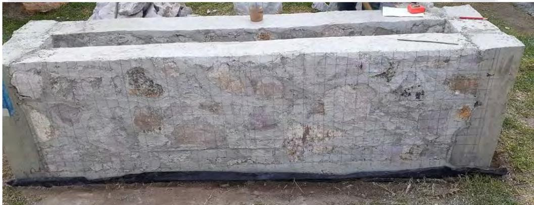
FIGURA 33 Redícula en el modelo experimental parte posterior. Elaboración Propia.
