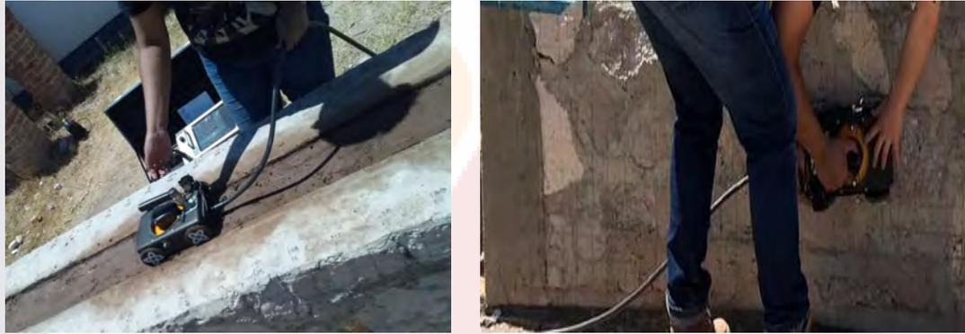
*FIGURA 39 Sondeos con GPR en el muro experimental. Superior y lateral. Elaboración Propia.*
