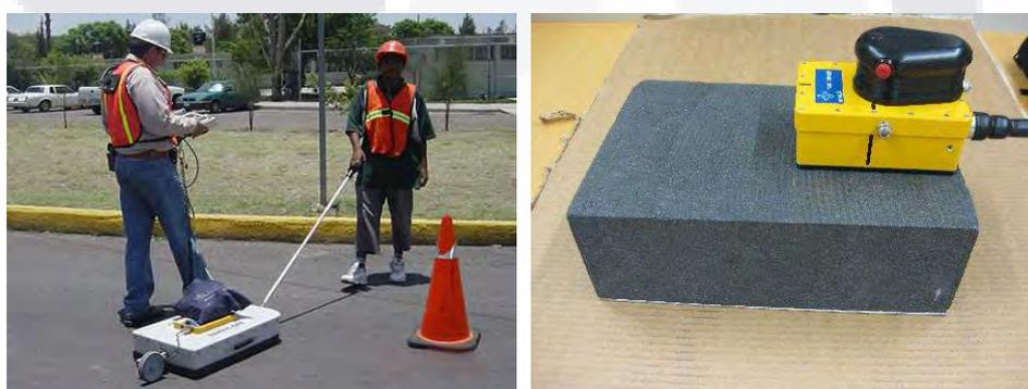
FIGURA 5 Diferentes tipos de antenas utilizadas como GPR. Tomada de (Unit, 2021) y (Geoelec, 2021)
