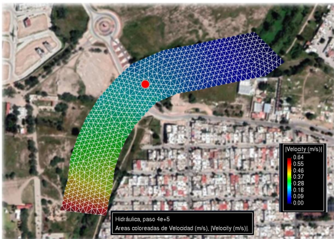
Figura 20.- Modelo de áreas de velocidad de flujo tomado 250 m aguas arriba y 250 m aguas debajo de la ubicación del puente (elaboración propia)
