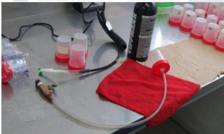
**Figura 11.** Tanque de CO2 modificado y adaptado para conectarse con los tubos donde se mantuvieron vivas a las arañas.
