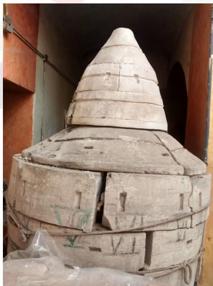
Imagen 60 Molde para pieza grande. Captura propia
