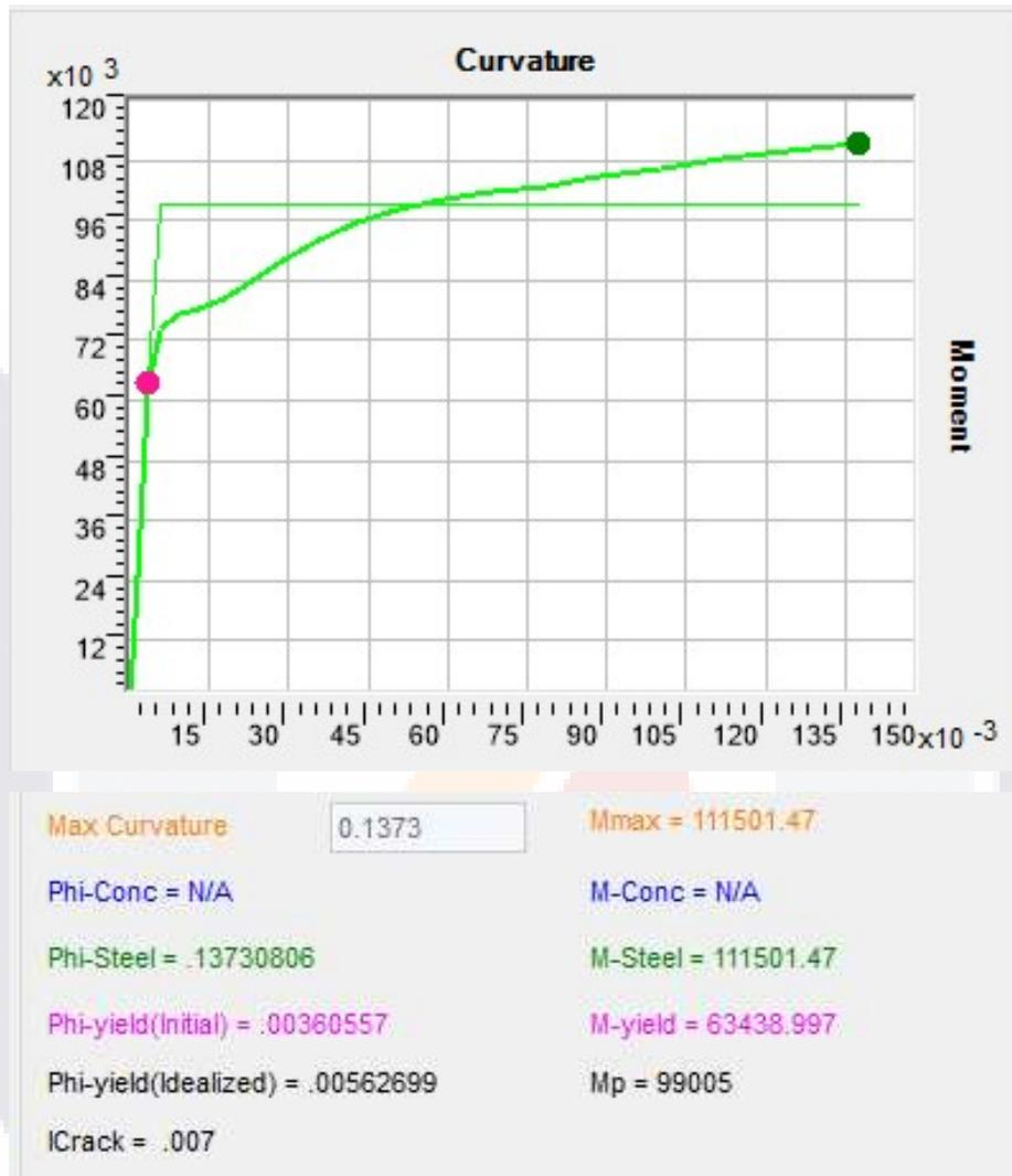
Figura 32. Diagrama Momento Curvatura para la trabe rectangular de 80 x 80 cm.
