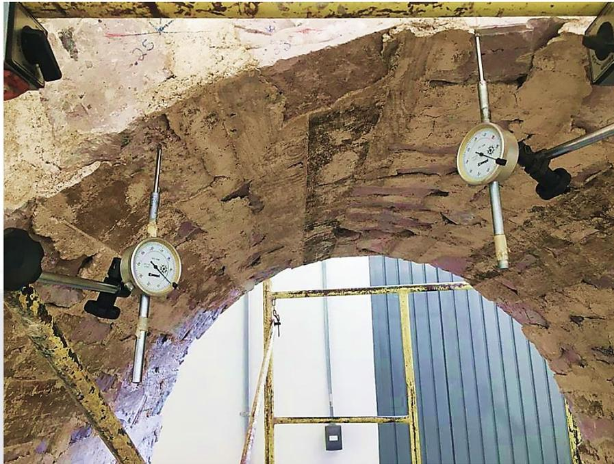
Figura 41 Micrómetros instalados y dispuestos en el intradós del modelo a escala. Elaboración propia.
