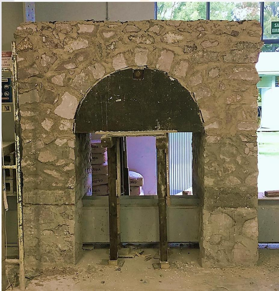
Figura 57 Modelo a escala durmiendo para alcanzar el fraguado correcto. Elaboración propia.
