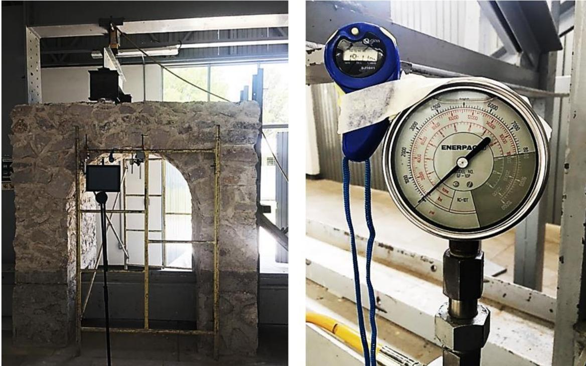
Figura 59 Modelo a escala instrumentado con cámaras y micrómetros
