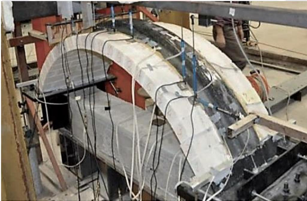
Figura 8 Arco tipo cañón, ensayado con un refuerzo de polímeros de carbono. (Ananía *et al.*, 2016)
