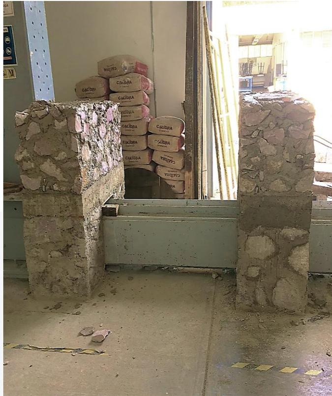
Figura 49 Pilas a nivel, empadado con la línea de impostas. Elaboración propia.
