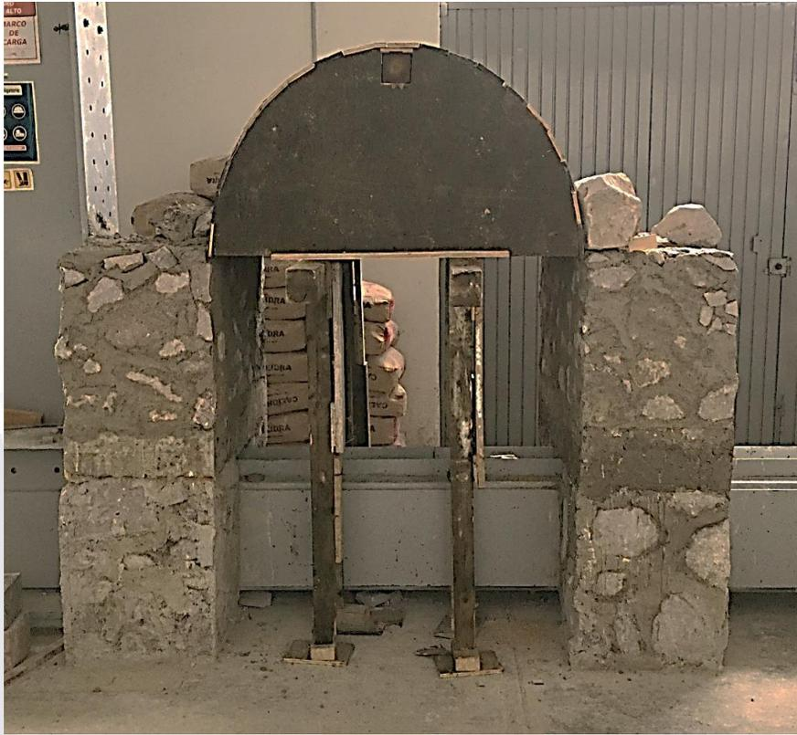
Figura 50 Colocación del salmer para arranque del arco. Elaboración Propia.
