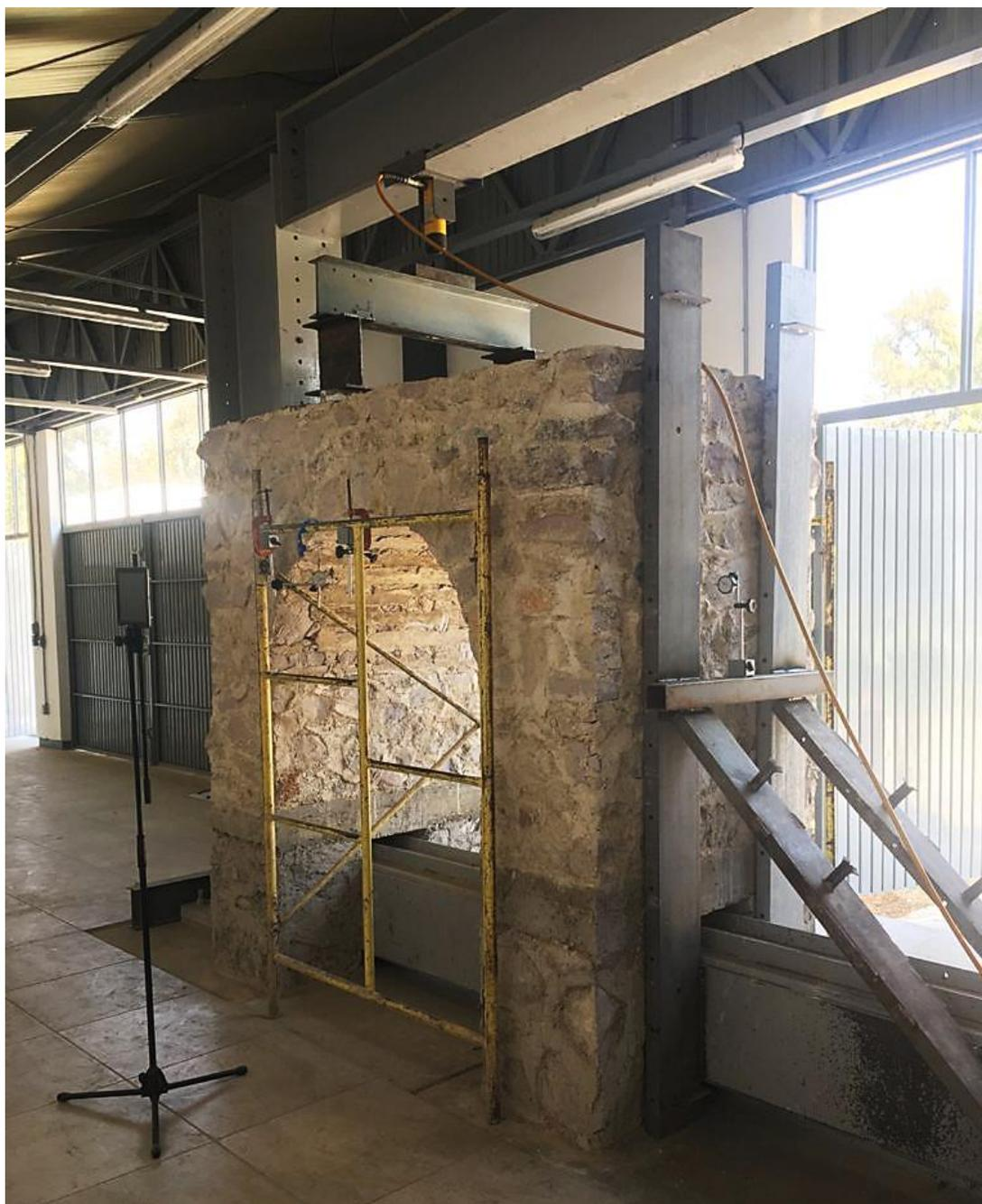
Figura 45 Modelo instrumentado listo para el último ensayo. Elaboración propia.
