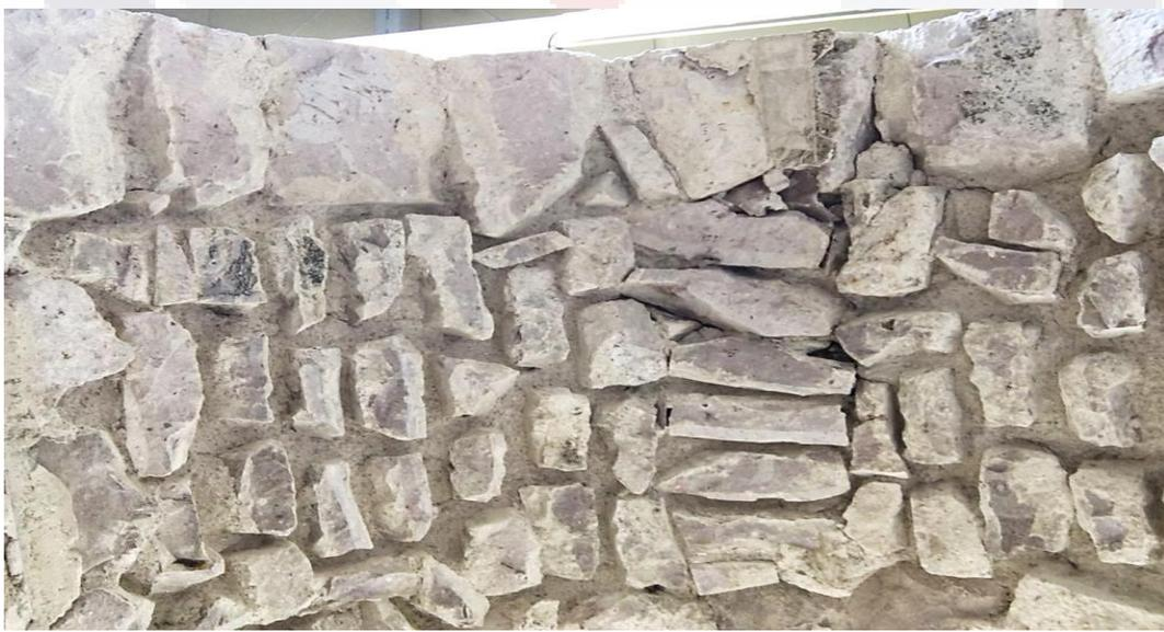
Figura 17 Intradós de modelo a escala con juntas desgastadas. Elaboración propia.
