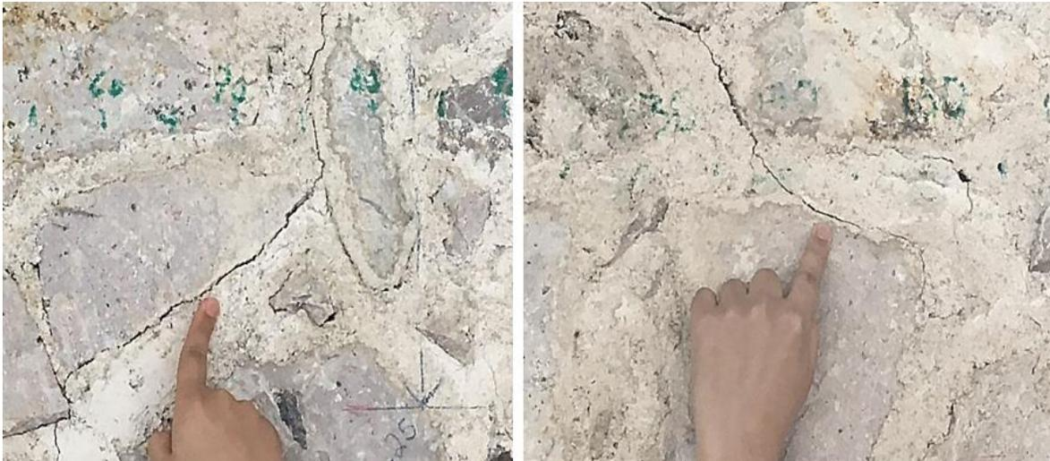
Figura 71 Rotulas plásticas generadas con la aplicación de carga. Elaboración propia.
