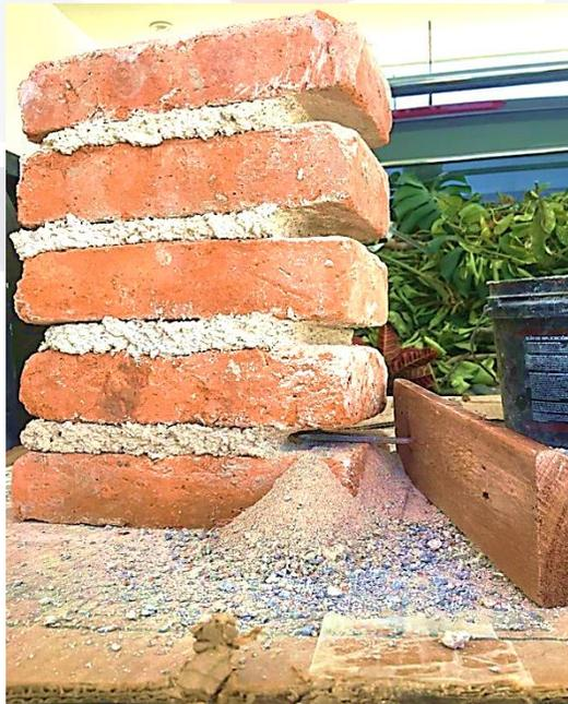
Figura 20 Pila de tabique con 10% de desgaste en la junta. Elaboración propia.
