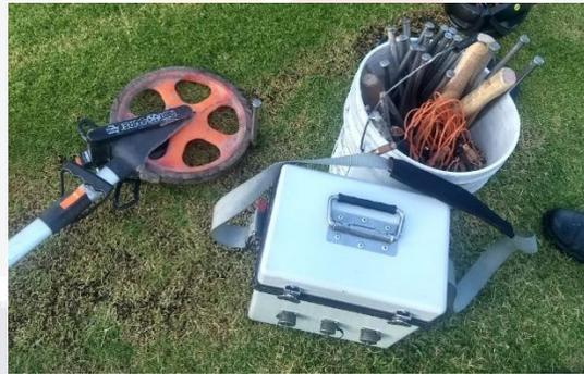
Figura 1 Equipo para mediciones de resistividad eléctrica.
