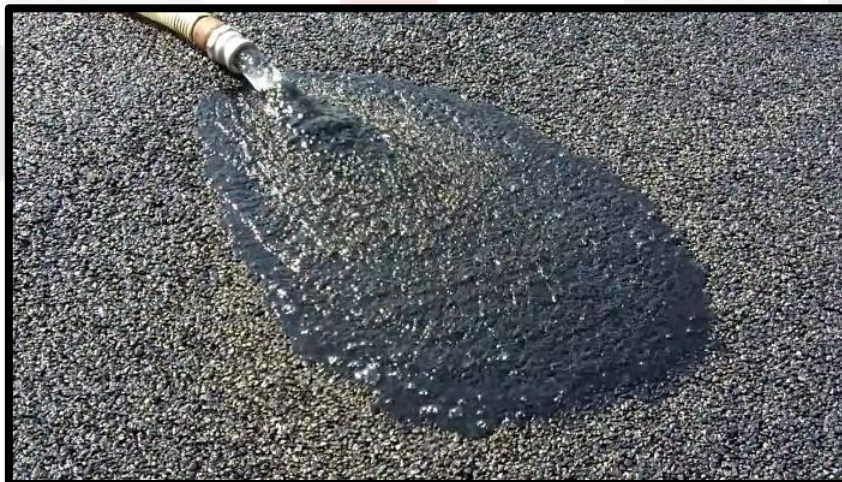
Figura 11. Demostración de la conductividad hidráulica del asfalto permeable. Obtenido de Asphalt Institute (2010).
