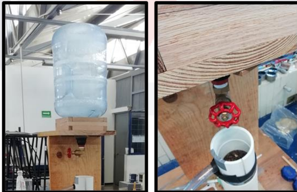
Figura 35. Colocación del tanque de almacenamiento en el permeámetro de carga constante. Fuente: autoría propia.
