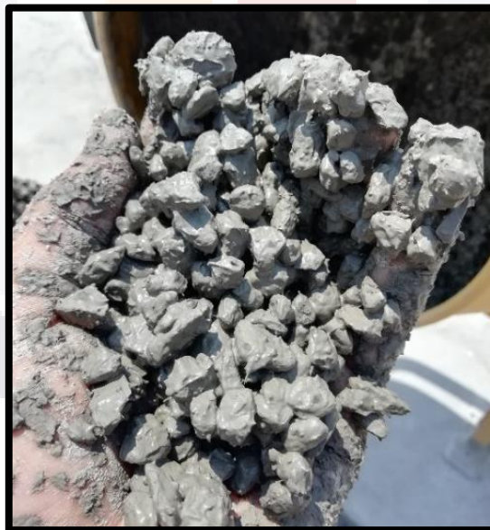
Figura 27. Brillo característico de una mezcla de concreto permeable, utilizando una relación agua-cemento adecuada. Fuente: autoría propia.
