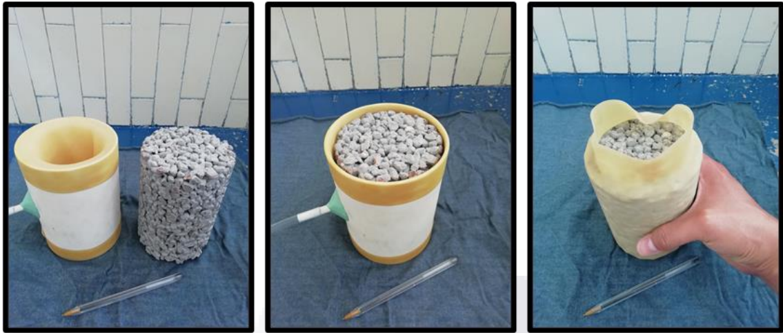
Figura 34. Colocación apropiada de la membrana de látex en los cilindros de concreto permeable para evitar rasgadas. Fuente: autoría propia.
