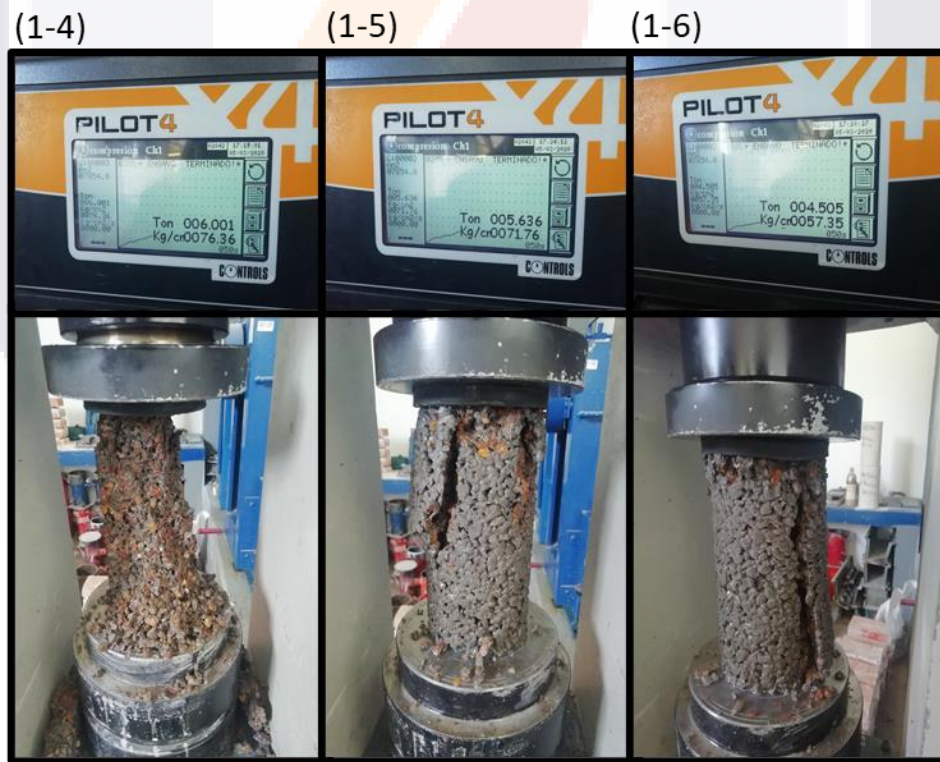
Figura 38. Modelos de fractura de los ensayos de resistencia a la compresión. Los números en la parte superior izquierda de cada figura indican el número de lote y el número de muestra, respectivamente. Fuente: autoría propia.
