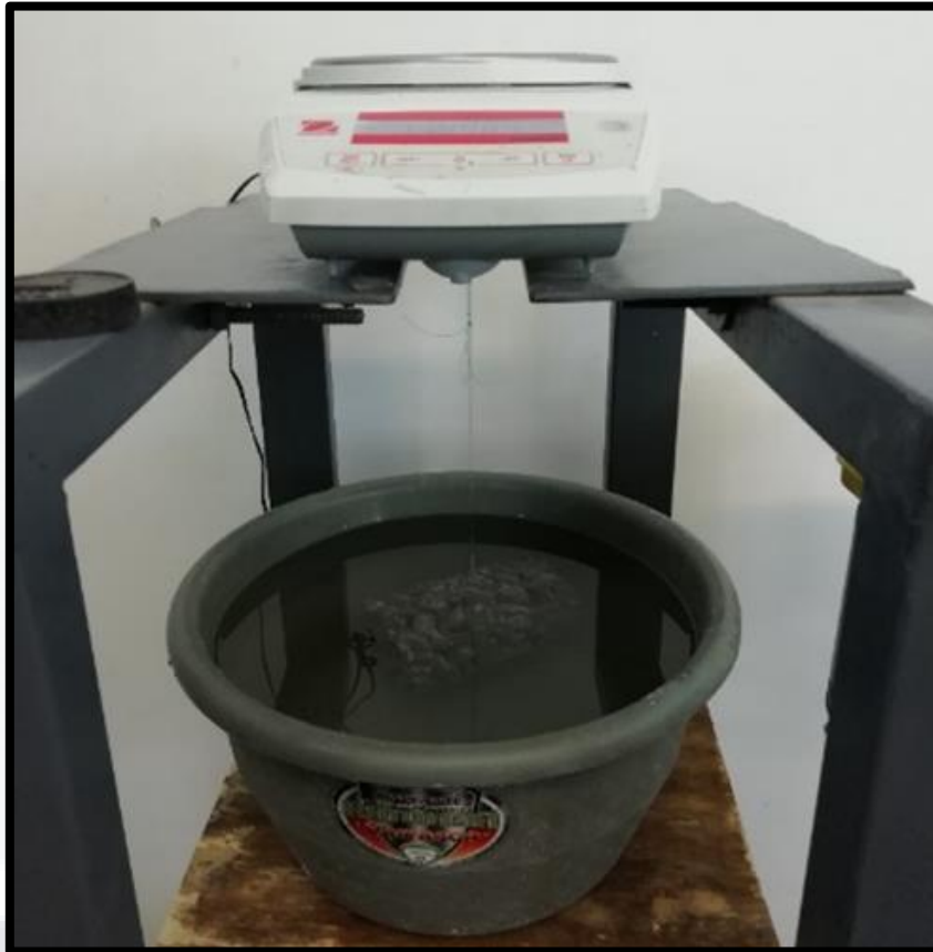
Figura 37. Determinación de la masa saturada sumergida en agua de las muestras de concreto permeable. Fuente: autoría propia.
