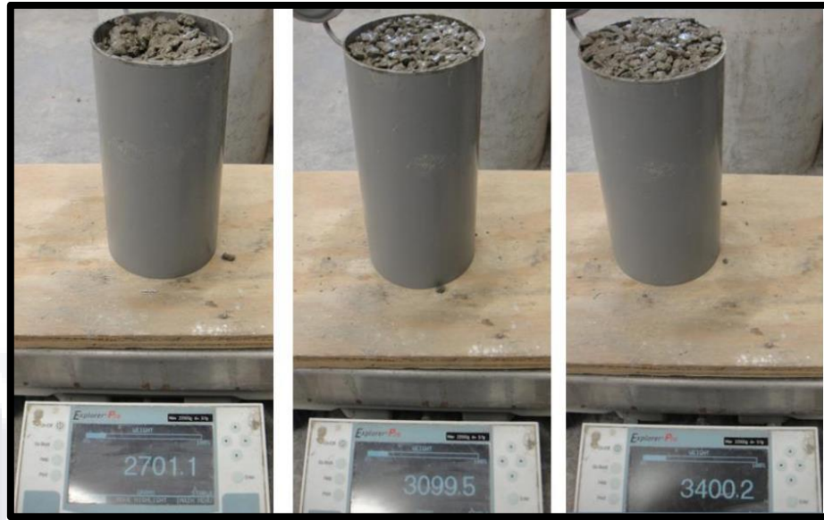
Figura 9. Diferentes cantidades de material de relleno fresco de concreto permeable en cada molde compactado para lograr la porosidad de diseño (Tomado de Tong, 2011).
