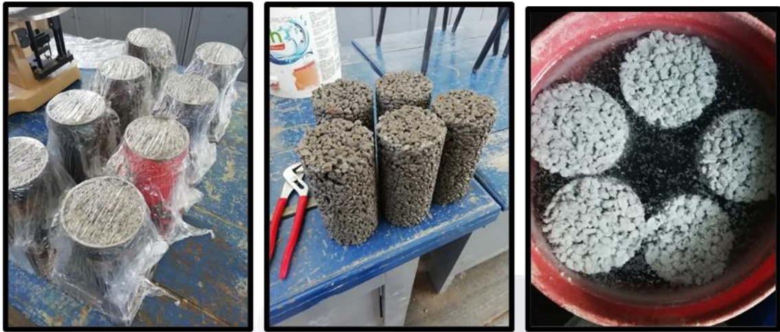
Figura 32. Procedimiento de curado de las muestras cilíndricas. Fuente: autoría propia.
