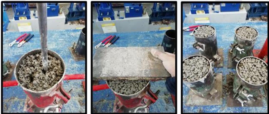
Figura 31. Procedimiento de fabricación de las muestras de concreto permeable. Fuente: autoría propia.
