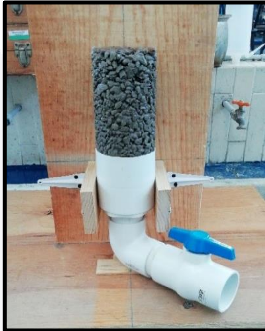
Figura 33. Etapa inicial de elaboración del permeámetro de carga constante. Fuente: autoría propia.
