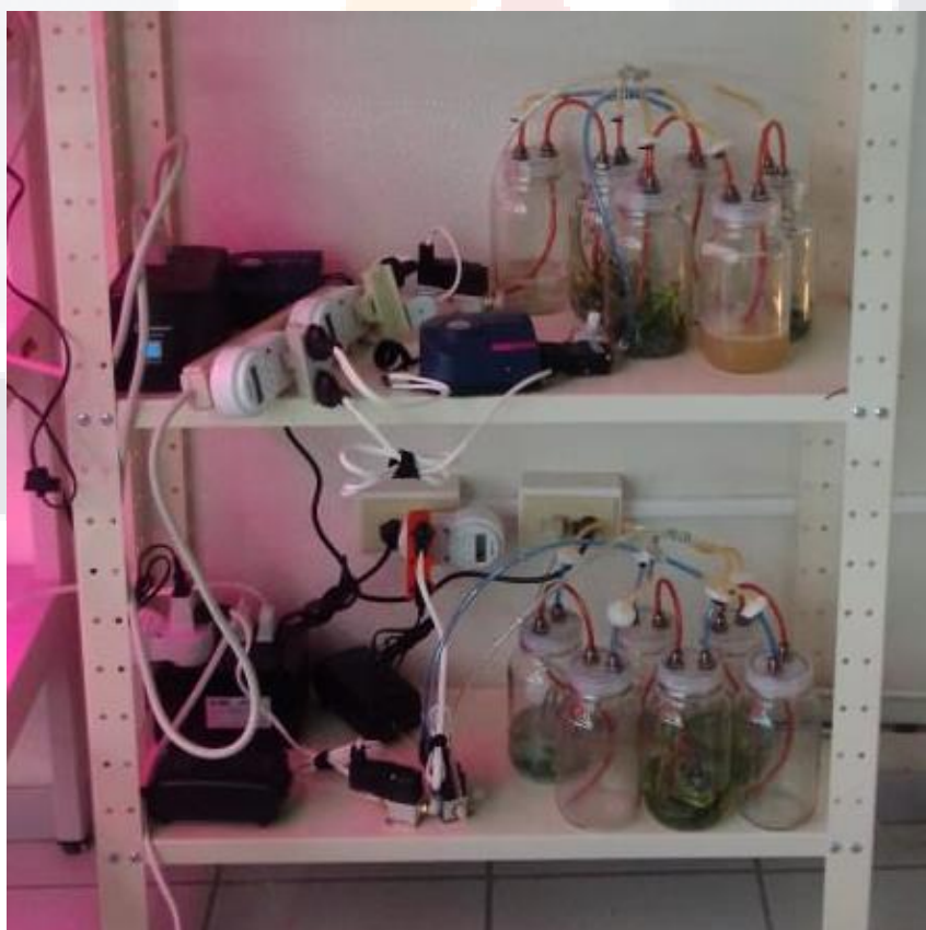
Figura 10: Ejemplares de sistemas de biorreactores de Inmersión Temporal modificado conectado completamente a las bombas y temporizadores, ya en funcionamiento.
