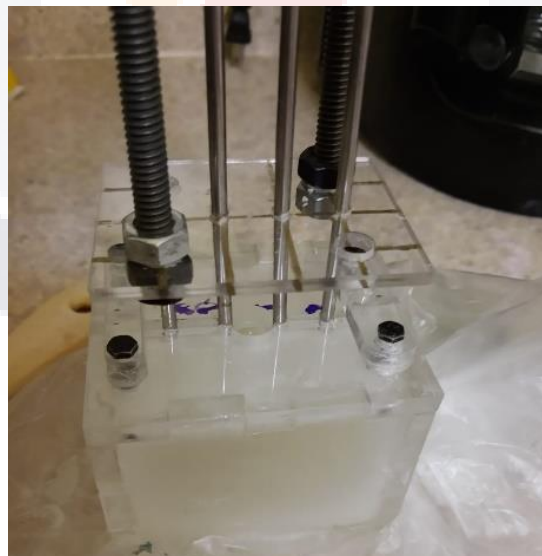
Figura 20. Molde para bloque de parafina con termopares tipo K.
