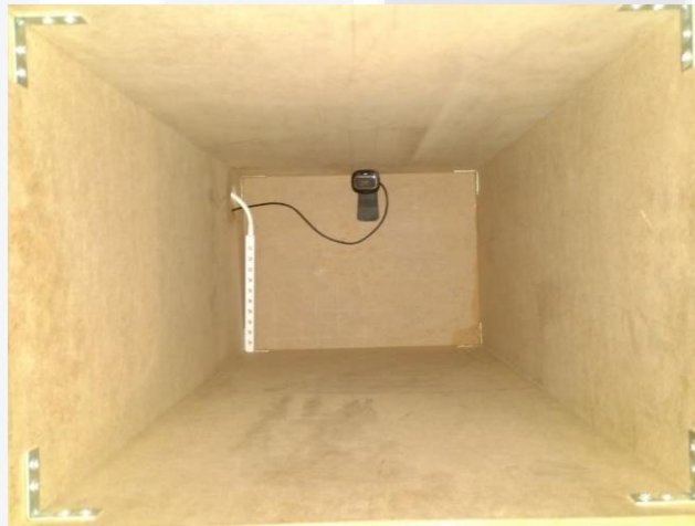
Cámara Microsoft HD 3000 y Barra led dentro de nuestra mesa
