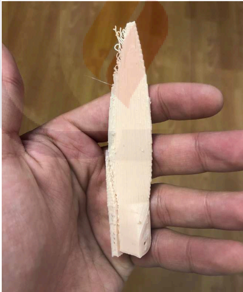
Muestra de una sección sin lijar de la hélice impresa en 3D.
