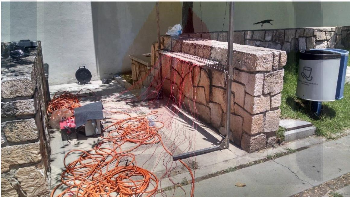
Figura 43. Prueba automática ERT en muro 1 mediante el sistema de acero para la colocación y fijación de electrodos.
