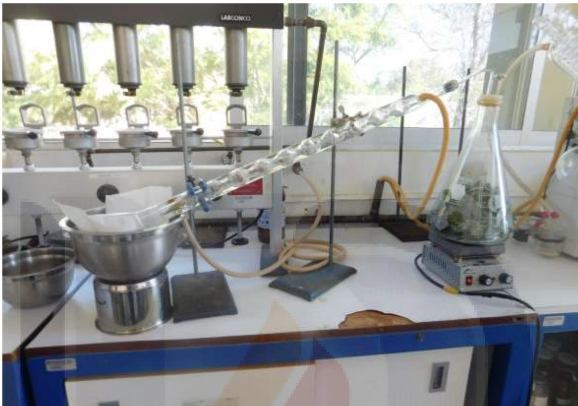
Figura 1. Instalación de destilador.
