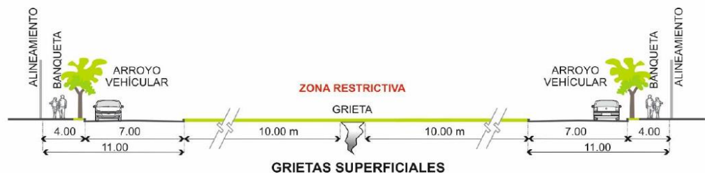
Figura 27. Sección de restricción, 10 m.
