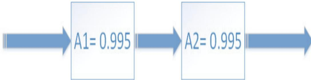
Figura 17. Sistema con dos componentes en serie (Calculating Total System Availability, 2014).
