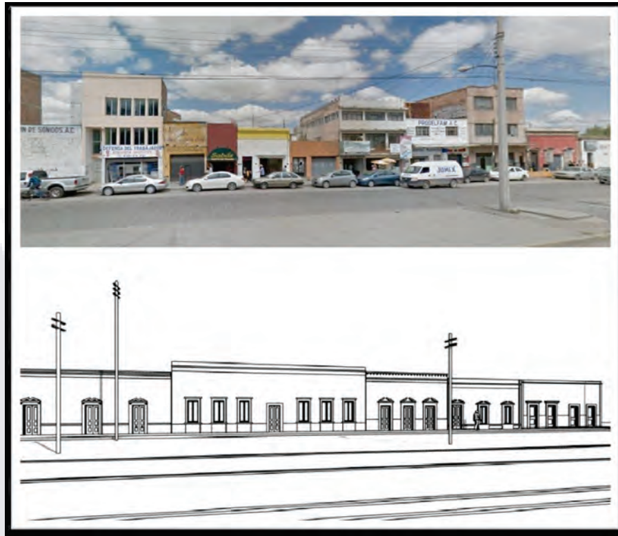
Imagen 6.36 Reconstrucción hipotética basada en las imágenes existentes de las fachadas originales en contraposición de las actuales en la cuadra norte de la calle Manuel José Othón en la zona de estudio.
