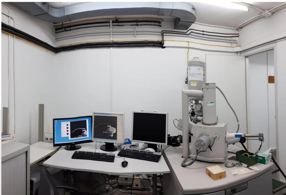
Figura 12. Microscopio Electrónico de Barrido (MEB) que se utilizó en este trabajo.
