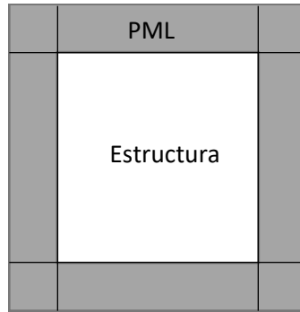
Figura 2.6. Ilustración de la distribución de PML en un modelo computacional.
