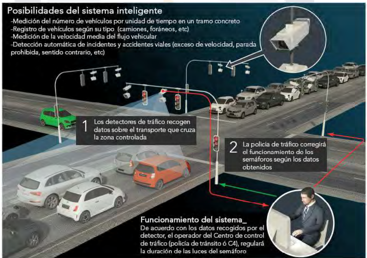
Figura 104. Esquema de funcionamiento de semáforos inteligentes
