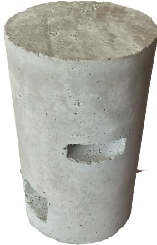
Ilustración 23 cilindro de concreto con forma irregular
