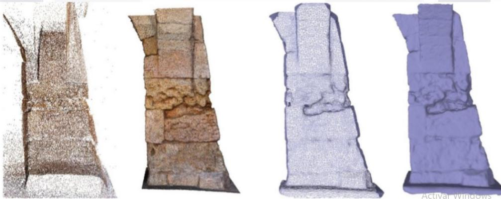
Ilustración 39 Proceso fotogramétrico, a) Nube de puntos densos, b) Nube de puntos dispersos c) Mallado d) Textura.
