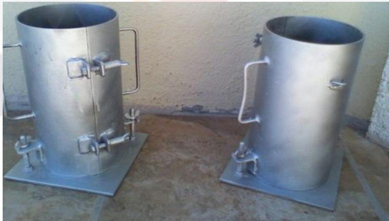
Ilustración 22 Moldes de cilindros de concreto
