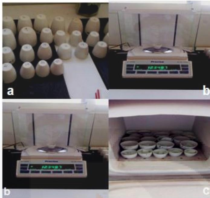
*Figura 14 Determinación de cenizas o materia inorgánica. a) Identificación los crisoles b) peso de los crisoles c) combustión de la muestra d) peso del crisol con las cenizas.*
