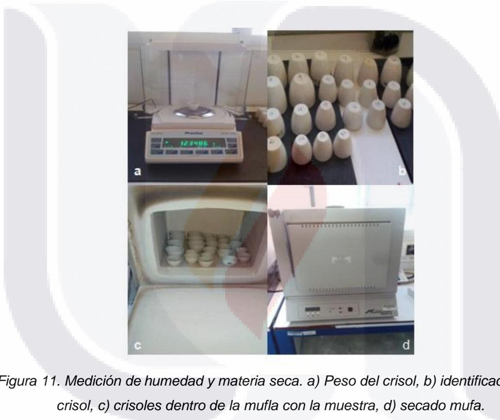
Figura 11. Medición de humedad y materia seca. a) Peso del crisol, b) identificación del crisol, c) crisoles dentro de la mufla con la muestra, d) secado mufla.
