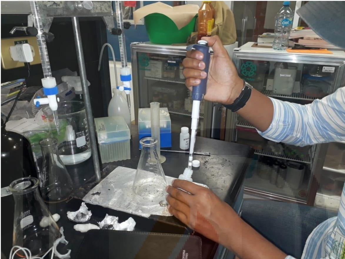
Figura 20 Titulación de NaOH para obtener el contenido de C. Una vez que se determinó el contenido de C en las muestras, se calculó el Carbono de la biomasa microbiana mediante la siguiente fórmula:
