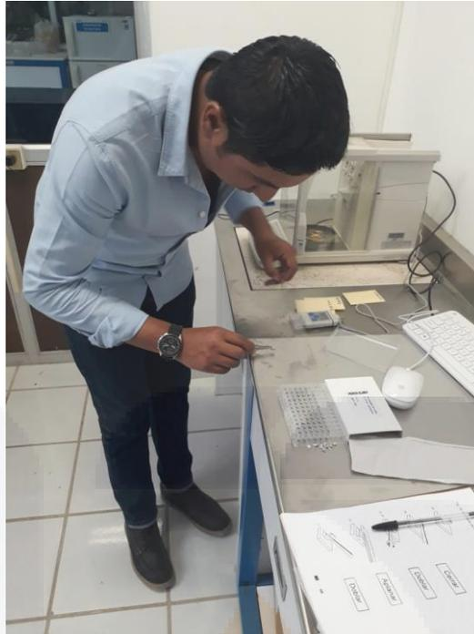
Figura 15. Pesado y encapsulado de las muestras de suelo, mediante el manual de Perkin Elmer 2400 Series II.
