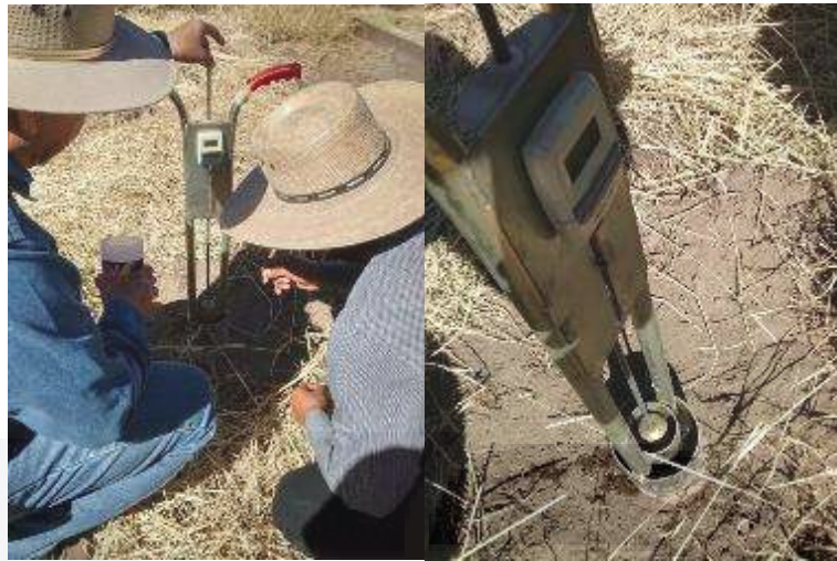
Figura 11. Toma de datos de infiltración con mini-infiltrómetro de doble anillo.
