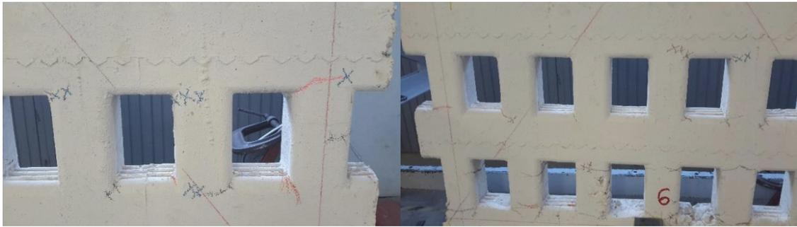
Ilustración 19 Fase 9, desplazamiento lateral de 21.6mm, propagación de grietas a cortante.
