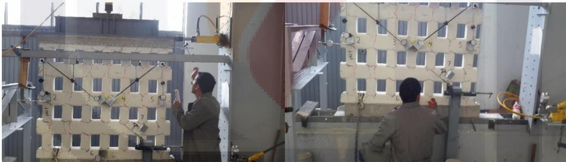
*Ilustración 27 Fase 13, desplazamiento lateral de 24.0mm, ancho de grietas de 5mm y trituración de la parte inferior del muro.*
