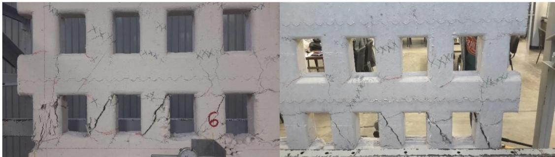
Ilustración 21 Fase 11, desplazamiento de 28.8mm, trituración de núcleos verticales de concreto.
