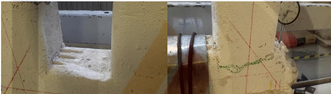
*Ilustración 17. Fase 7, desplazamiento lateral de 14.4 mm, propagación de grietas horizontales.*
