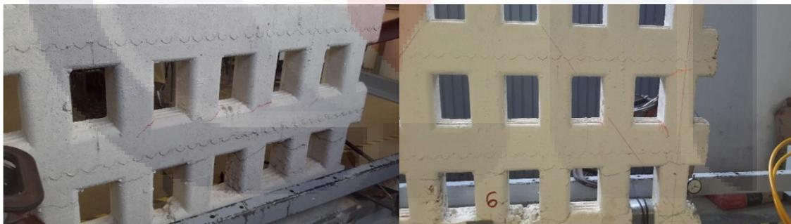
*Ilustración 18 Fase 8, desplazamiento lateral de 18mm, inicio de grietas a cortante.*
