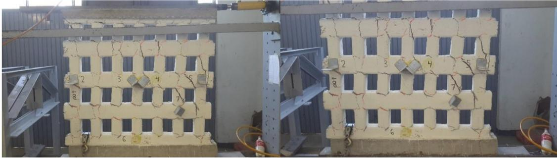
*Ilustración 28 Fase 14, desplazamiento lateral de 24.0mm, trituración de núcleos de concreto verticales y horizontales, ancho de grietas de 10mm.*
