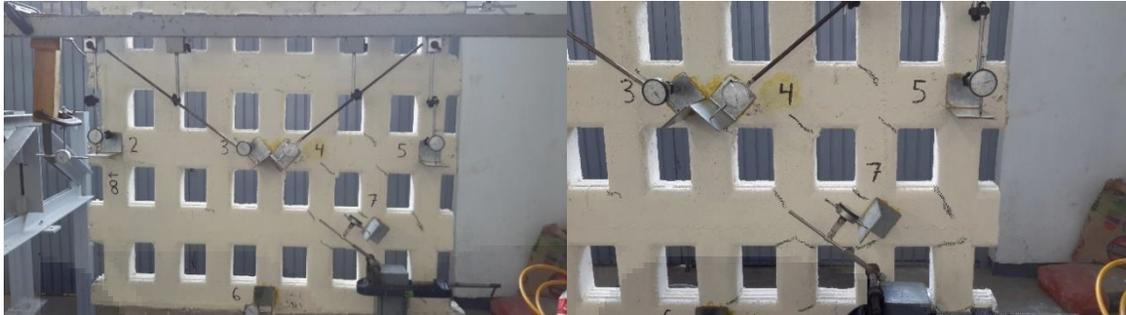
*Ilustración 22 Fase 8, desplazamiento lateral de 12.0mm, inicio de grietas a cortante.*
