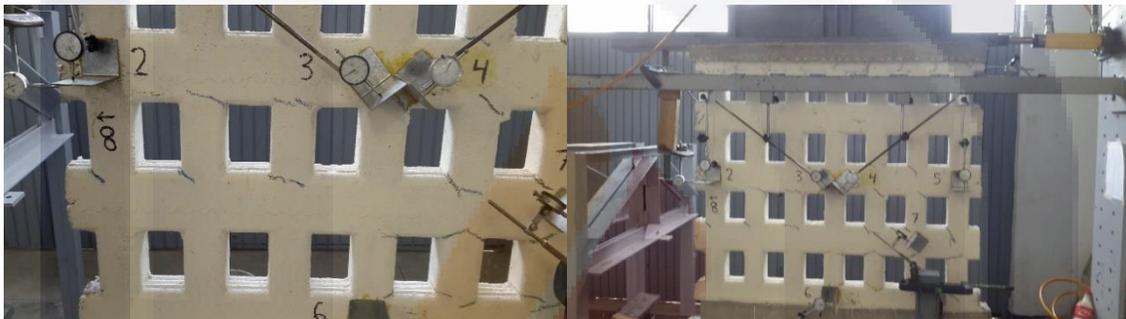
*Ilustración 23 Fase 9, desplazamiento lateral de 14.4mm, agrietamiento diagonal.*
