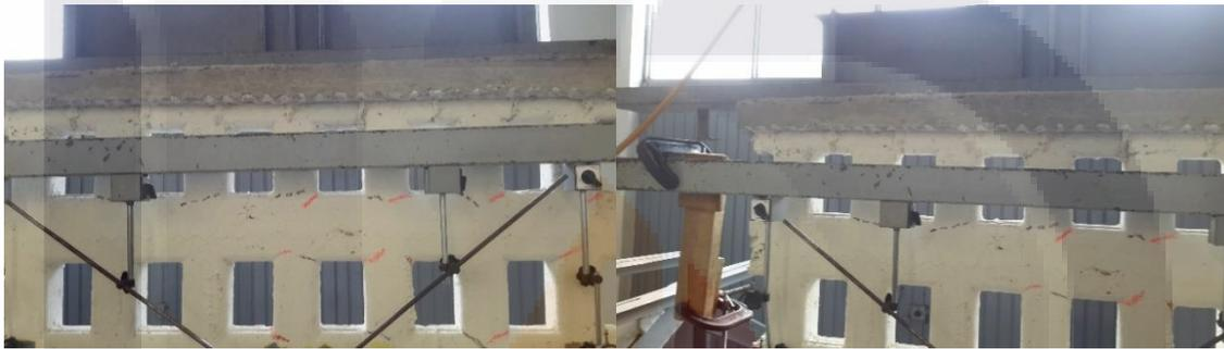
*Ilustración 26 Fase 12, desplazamiento lateral de 12.16mm, grietas de 4mm en muros y propagación de grietas considerable en parte superior de muro.*
