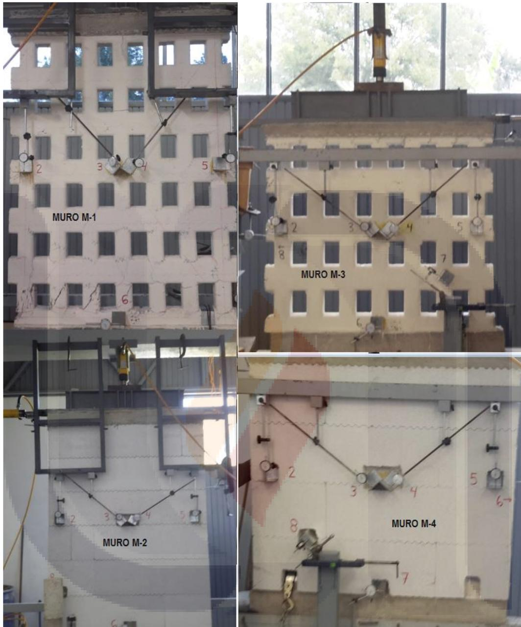
Figura 9. Ubicación de micrómetros en los diferentes muros.
