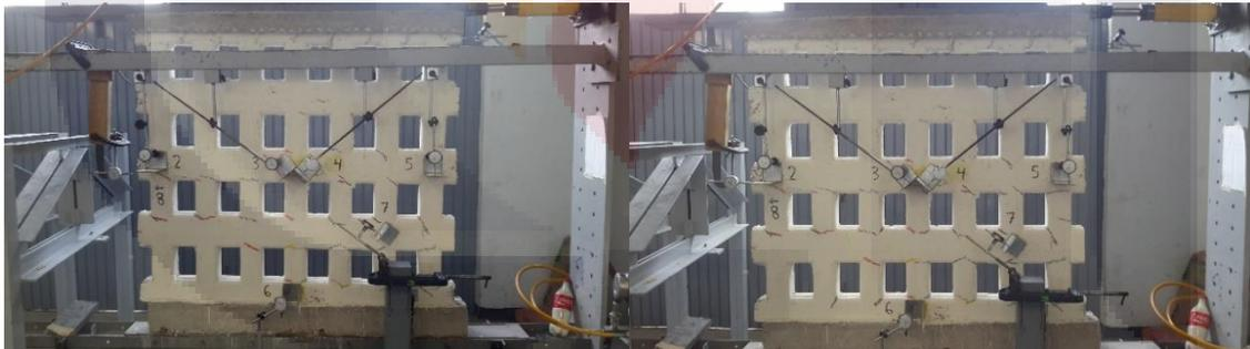
*Ilustración 24 Fase 10, desplazamiento lateral de 16.8mm, ancho de grietas de 1mm.*
