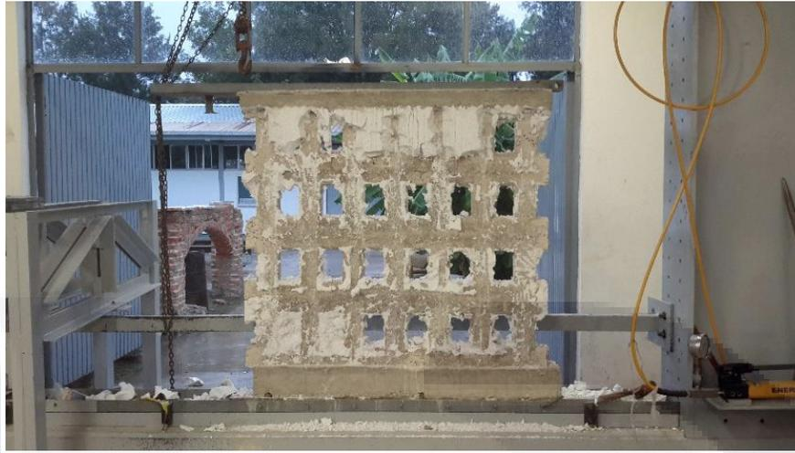
Figura 6. Retiro de EPS del muro.
