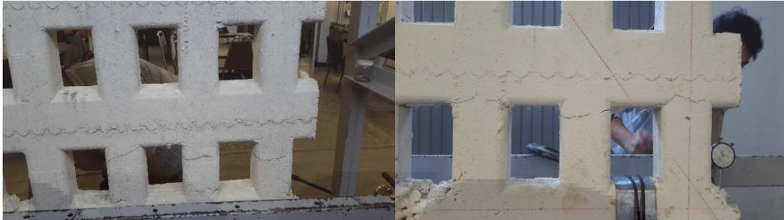
*Ilustración 16. Fase 6, desplazamiento lateral de 10.8mm, inicio de grietas horizontales, parte inferior de muro.*
