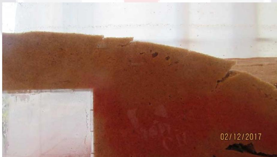
**Figura 46.** Agrietamientos en la capa superior.
