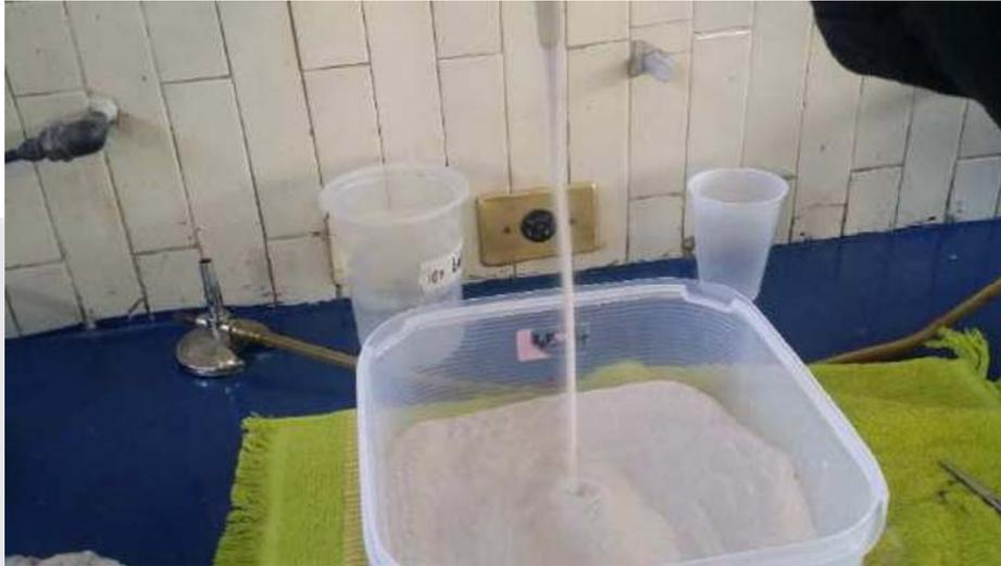
**Figura 31.** Llenado de prototipo con arena sílice
