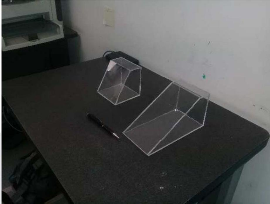
**Figura 36.** Geometrías utilizadas para simular basamento rocoso indeformable.
