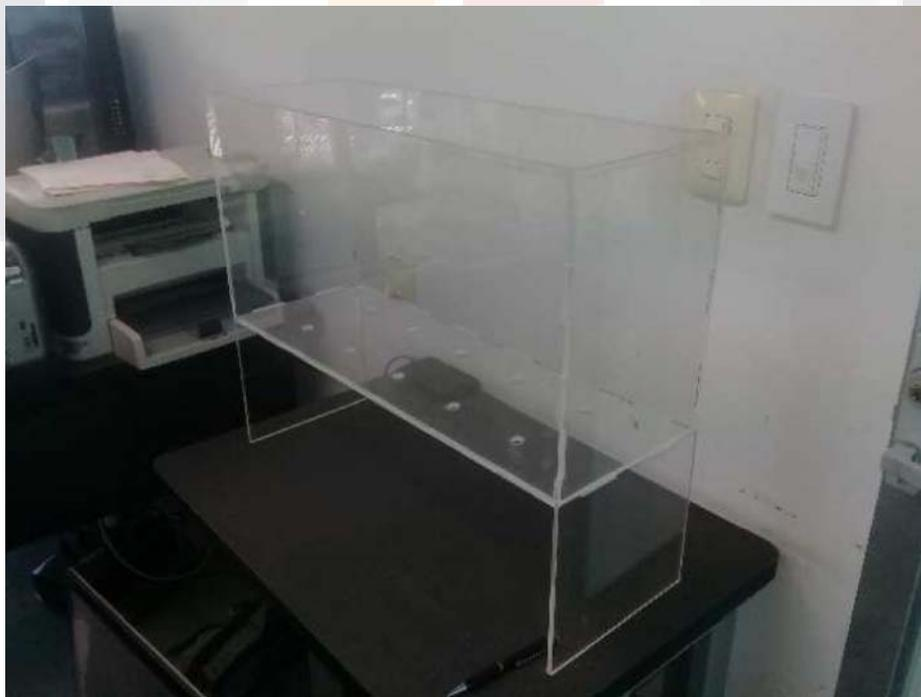
Figura 35. Modelo de acrílico con drenaje en la parte inferior.
