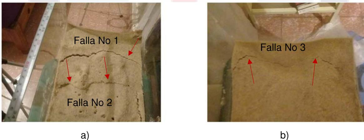
Figura 42. a) Vista del modelo, foto tomada hacia lado izquierdo, pendiente de basamento rocoso de  $90^\circ$  b) foto tomada hacia el lado derecho, pendiente de basamento rocoso  $60^\circ$
