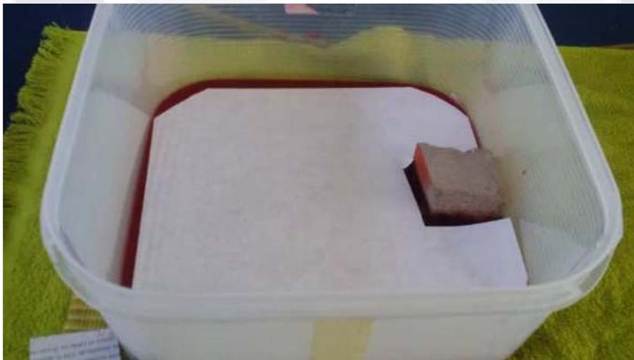
**Figura 30.** Papel bond como interface y cubo de concreto como basamento.
