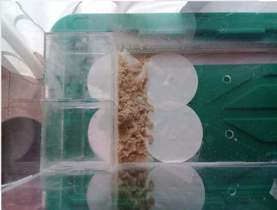
**Figura 41.** Colocación de papel filtro en drenajes.
