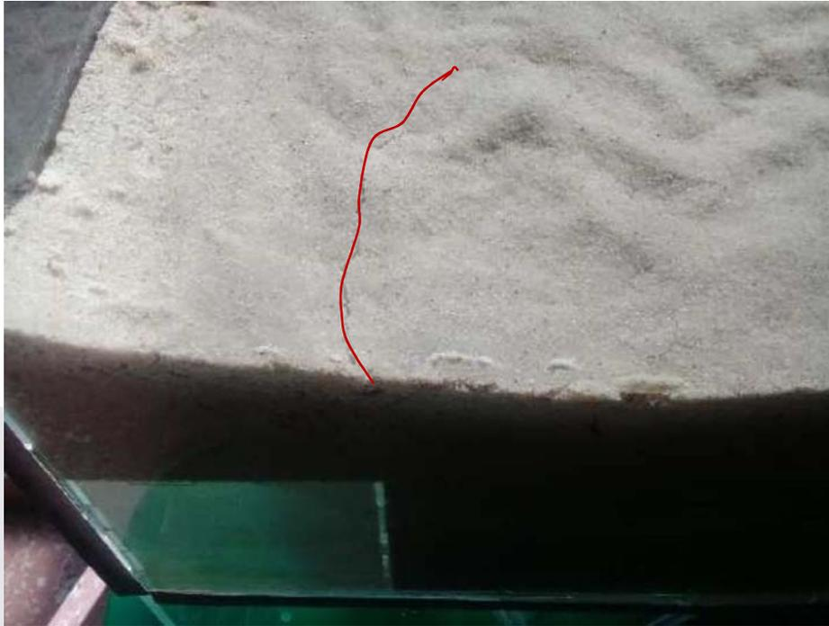
**Figura 49.** Falla por tensión en ensaye No 3
