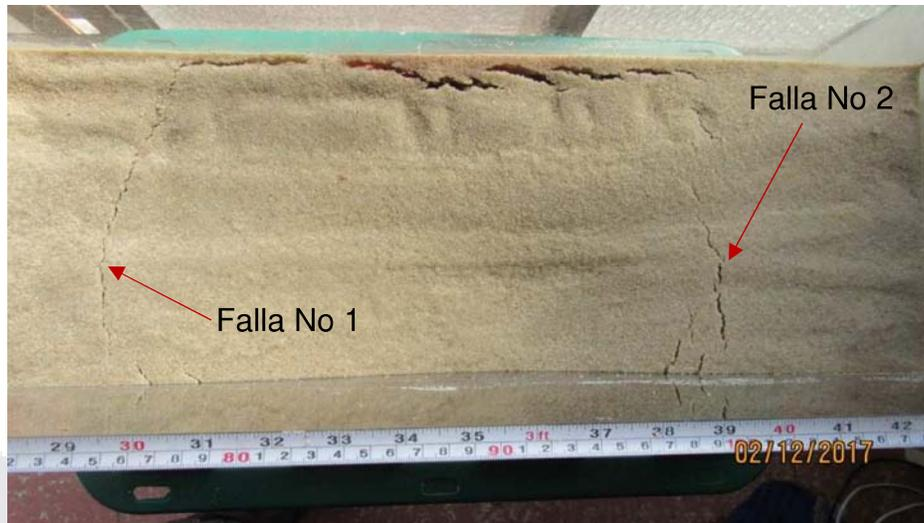
**Figura 45.** Formación de agrietamientos en ensayo No 2. Foto en planta
