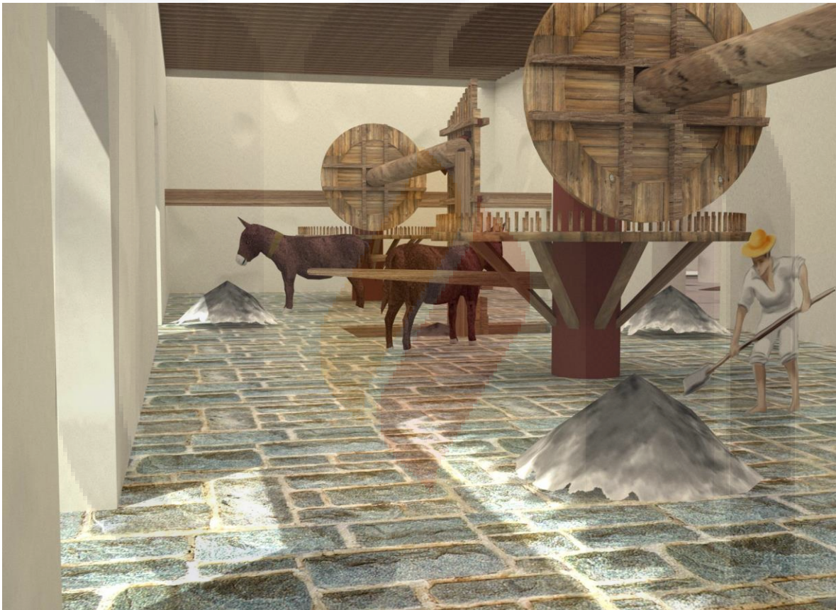
Ilustración 32: Los espacios productivos de la Hacienda Nueva estaban condicionados por la función y por las técnicas y materiales disponibles en el sitio y en la época. Así, los espacios cubiertos estarían sujetos a las limitantes de emplear madera para librar los claros y para tener los artilugios fijos para que pudieran accionarse. Fuente: José Humberto Flores Castro, mostrando los locales de primera molienda con mazos.
