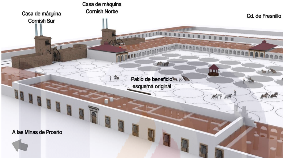
Ilustración 55: En este esquema, aparecen ya las casas de máquinas Cornish, con relación al esquema original del patio planeado con anterioridad, ya se ha demolido una sección de la arcada continua poniente. Fuente: José Humberto Flores Castro.
