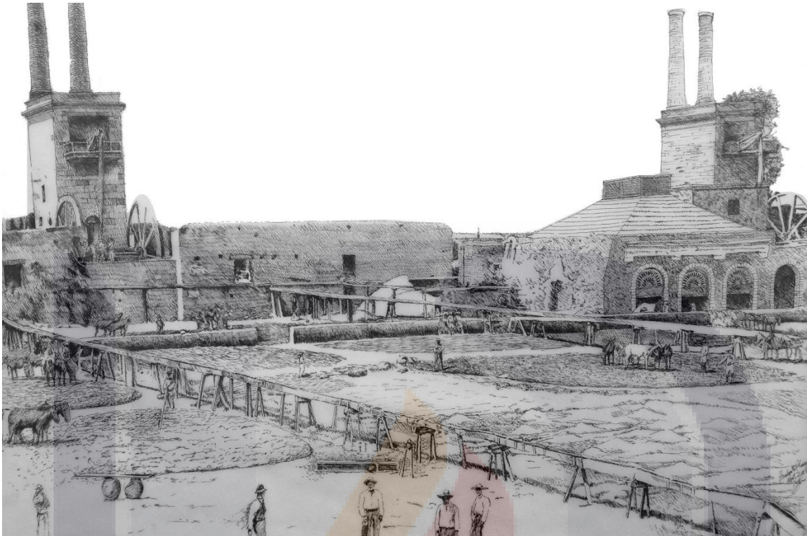
Ilustración 63: Dibujo de las dos casas de bombas Cornish, a la izquierda, la sur y a la derecha, la norte. Nótese las canalizaciones de madera adicionadas para llevar el mineral molido con agua al patio de beneficio. Fuente: José Humberto Flores Castro, en base a fotografía antigua que Brown asevera fue tomada en 1903.
