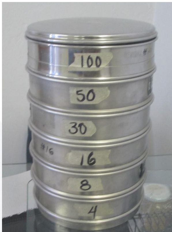
Figura 11. Juego de mallas utilizadas.
