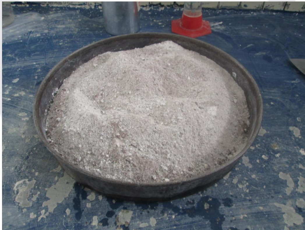
Figura 13. Mezclado de cal y agregado pétreo en seco.
