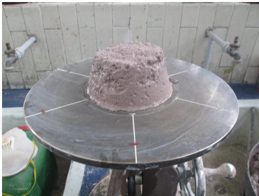
Figura 16. Mesa de impactos con mortero en estado inalterado antes de iniciar la prueba de fluidez.
