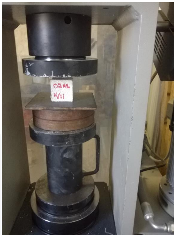
Figura 22. Prueba de compresión de probeta de mortero de cal.
