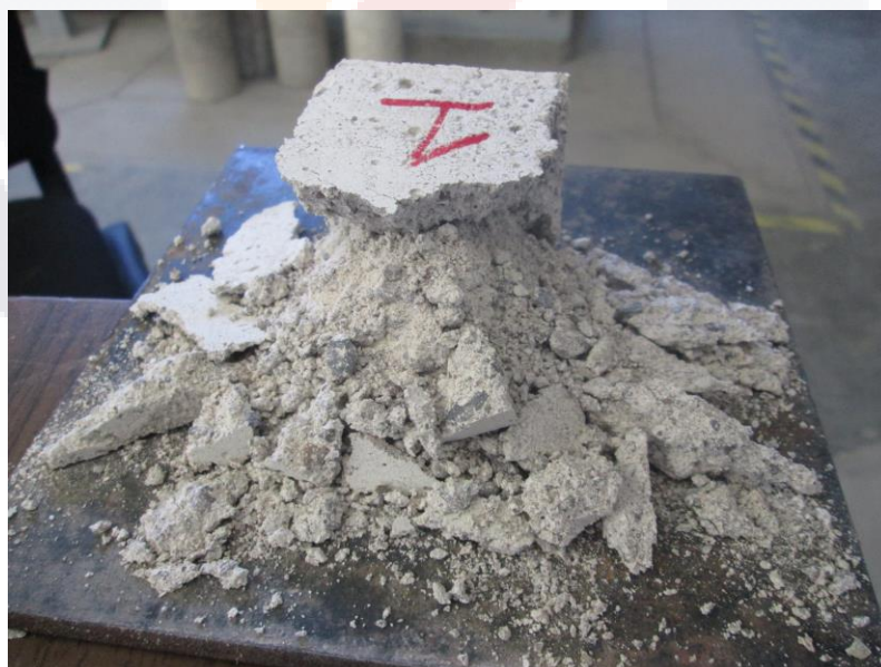
Figura 23. Probeta de mortero de cal luego de su ensayo a compresión.
