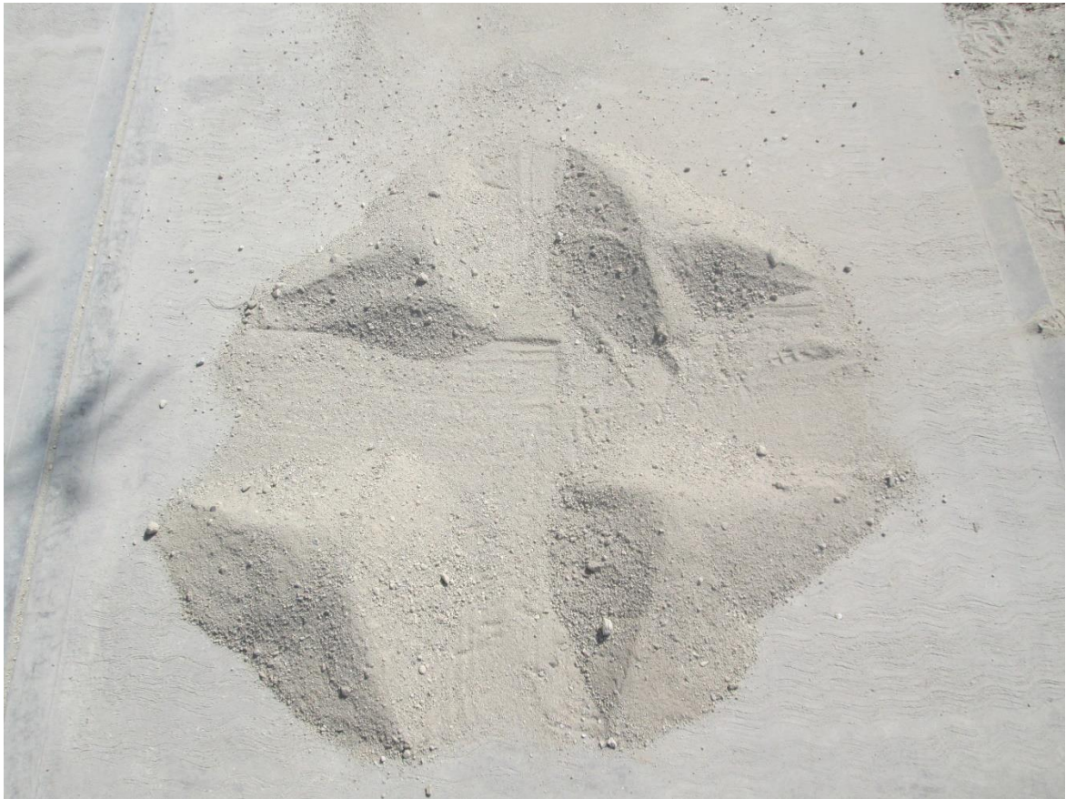
Figura 10. Cuarteo de la muestra.
