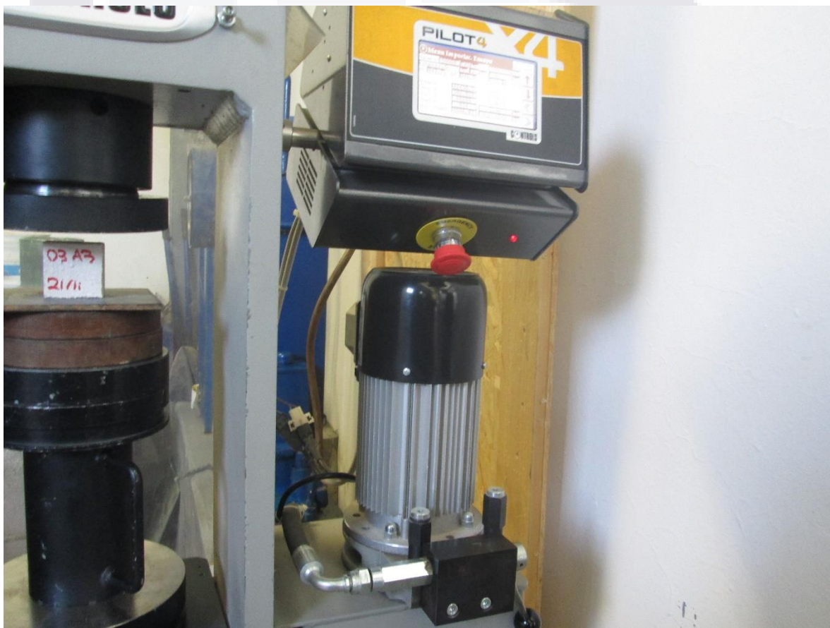
Figura 6. Prensa hidráulica para pruebas de compresión.
