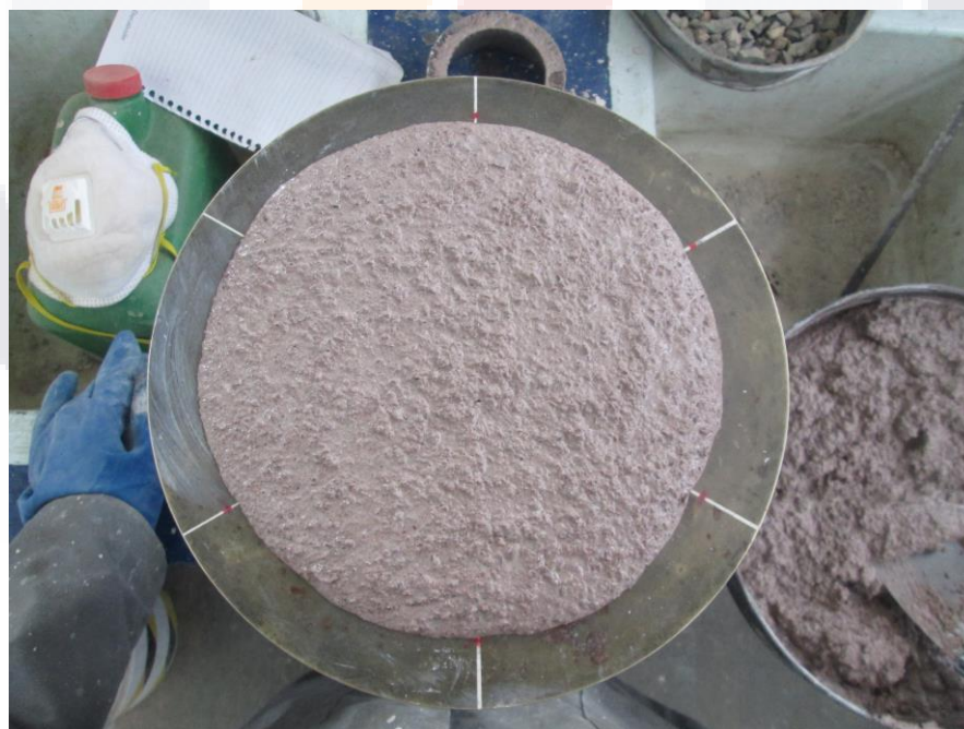
Figura 17. Medición del diámetro final del mortero tras finalizar la prueba de fluidez.
