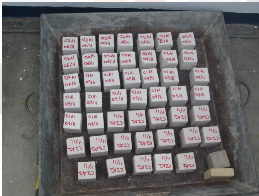
Figura 21. Probetas de mortero de cal de distintas dosificaciones.
