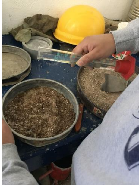
Figura 10. Saturación de suelo seleccionado, para obtener diferentes contenidos de humedad.
