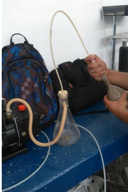
Figura 11. Aplicando bomba de vacío para determinar el peso específico relativo de salidos del suelo.
