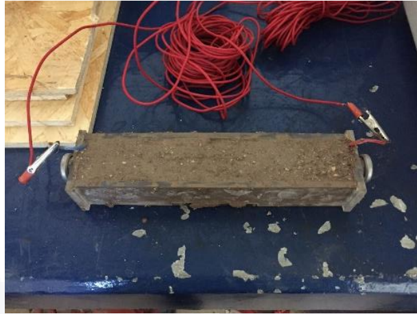
Figura 9. Método de prueba estándar para la medición de la resistividad del suelo, usando el método de caja de suelo con dos electrodos. La imagen de esta figura muestra el suelo dentro de la caja y los electrodos conectados a ambos extremos de la caja.
