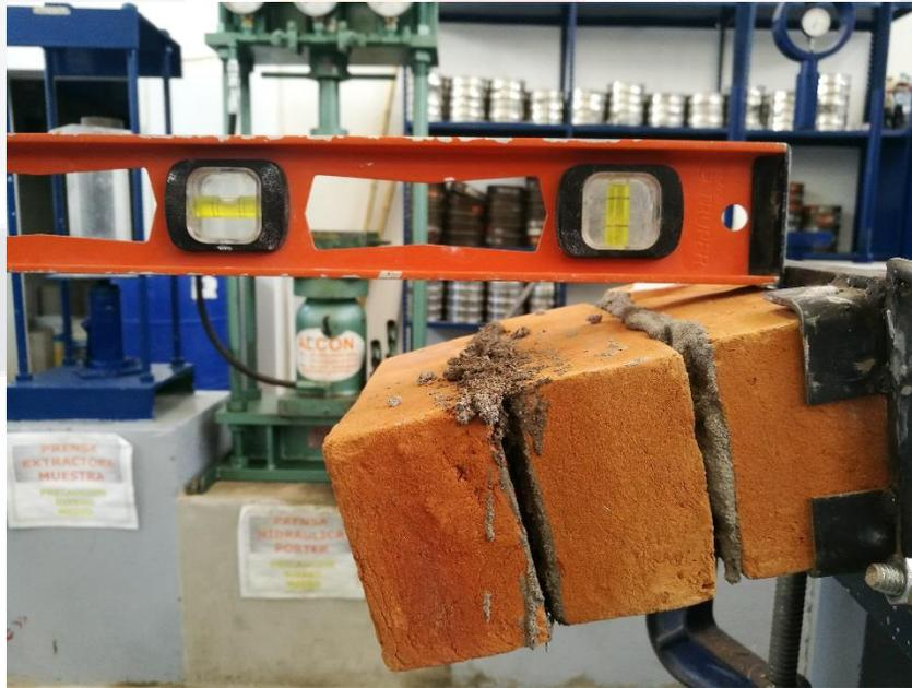
Figura 140. Cuñas juntadas en ángulo inferior a la horizontal.
