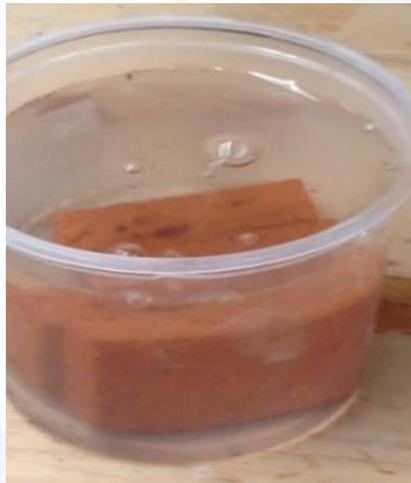
Figura 54. Cuña en proceso de saturación.
