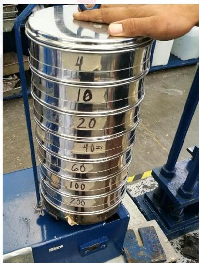
Figura 58. Cribado del material.
