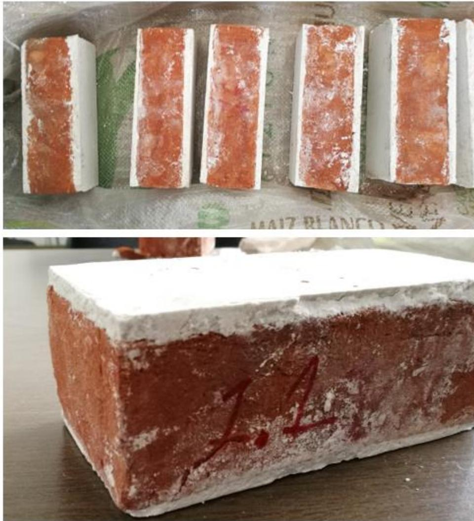
Figura 55. Cuñas cabeceadas previo a ensayo de compresión.
