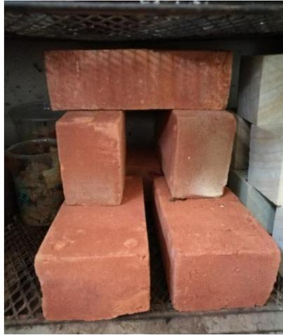
Figura 53. Cuñas dentro del horno para obtener su registro en seco.
