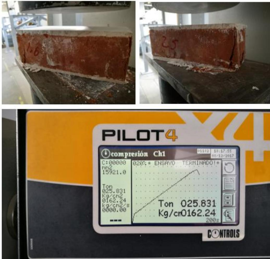
Figura 56. Ensayo de compresión en cuñas.
