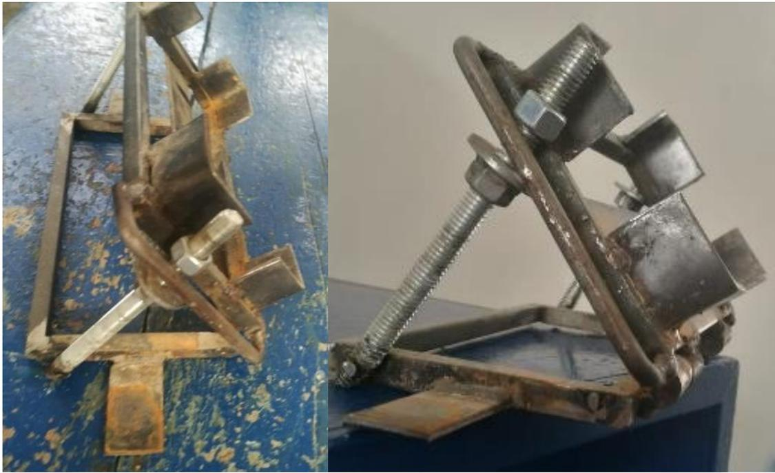
Figura 139. Prototipo diseñado y fabricado para observar adherencias en juntas de cuñas.
