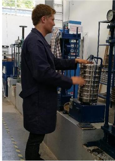
Figura 57. Ejecución de prueba de granulometría.
