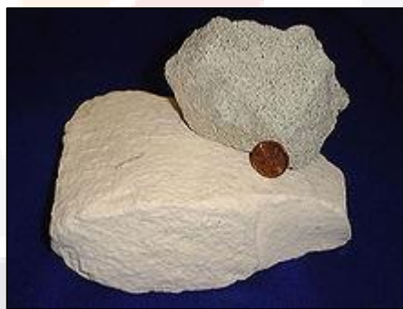
Figura 4 Rocas Ígneas y metamórficas con alto contenido de aluminio y sílice (Zeolita), https://es.wikipedia.org/wiki/Zeolita
