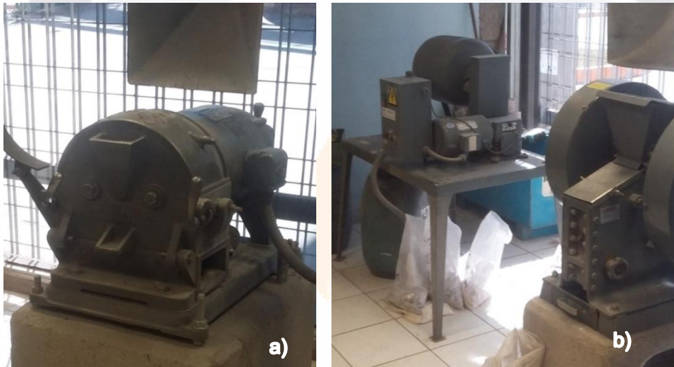
Figura 11 a) Pulverizador de 10 Hp de discos, b) Quebradora de quijadas de 10 HP y Molino de bolas de 12 lt y 10 Hp. (Fuente propia)
