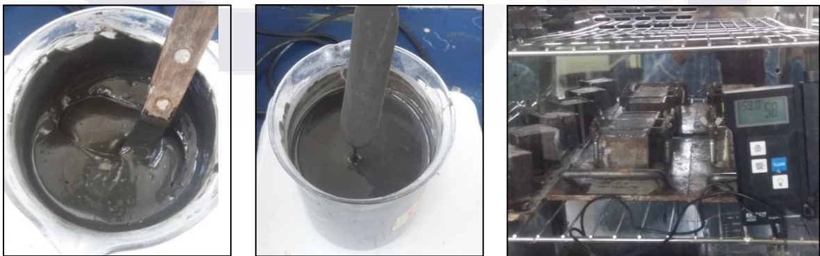
Figura 38 Pastas activadas a 250°C y curadas a 60°C y 60% humedad. (Fuente propia)
