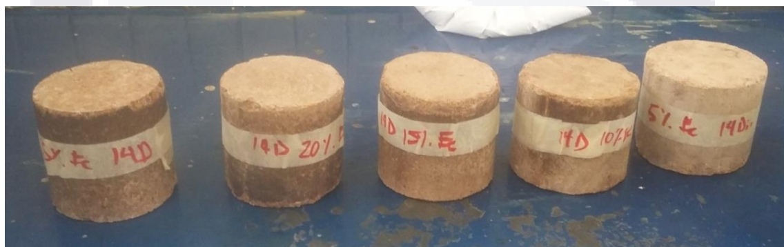
Figura 21 Probetas de suelo-escoria activada que presentaron una resistencia inferior a la norma. (Fuente propia)
