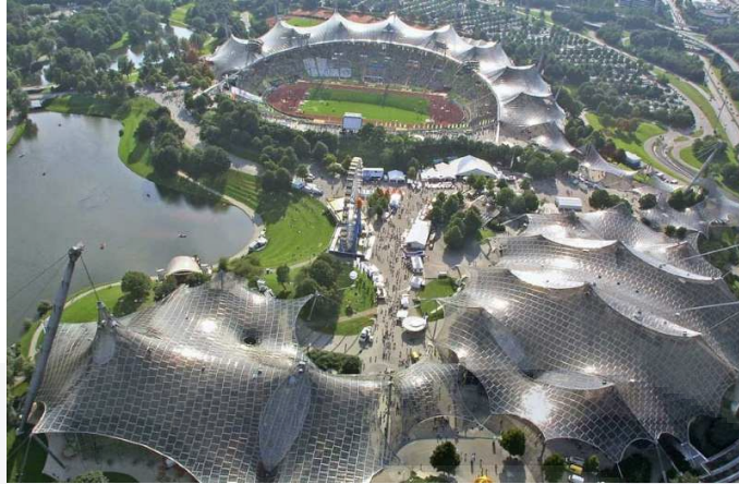
Figura 17: Cubierta apoyada en puntos en estadio olímpico de Múnich
