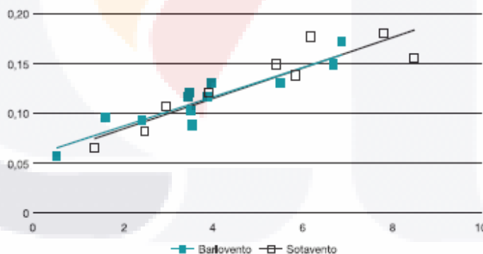
Figura 77: Tasa de ventilación m^3/m^2s en función de la velocidad del viento (m/s) en invernaderos con ventana de tipo enrollable
