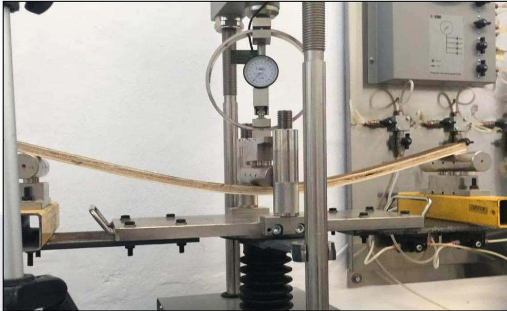
Figura 8. Ensayo a flexión estática en probeta de 770 x 50 mm de madera contrachapada.
