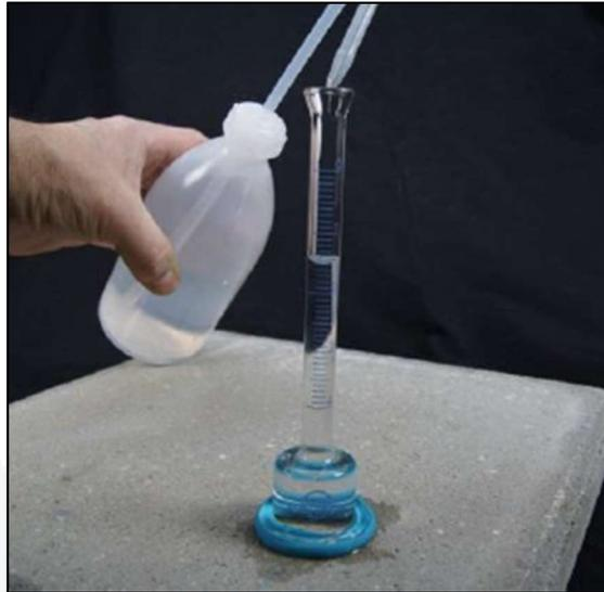
Figura 20. Método de ensaye de permeabilidad horizontal con el tubo de Karsten.
