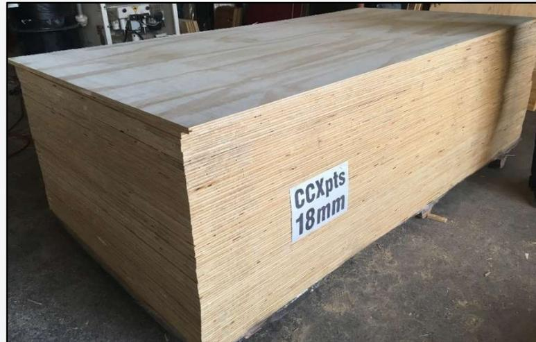
Figura 26. Lote de *triplay* de 18 mm con cara y trascara de calidad C, de origen uruguayo.
