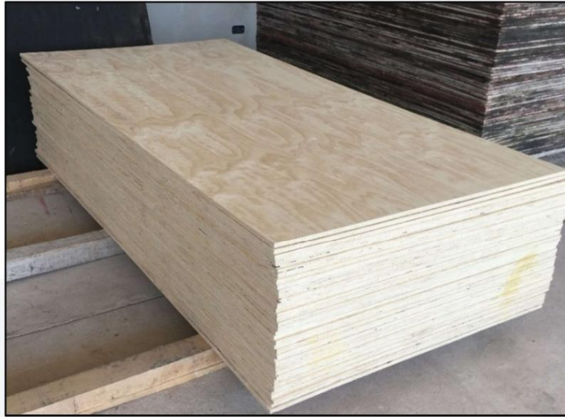
Figura 22. Lote de *triplay* nuevo con dimensiones de 1.22 x 2.44 m, de 15mm de espesor nominal, pulido a una sola cara.
