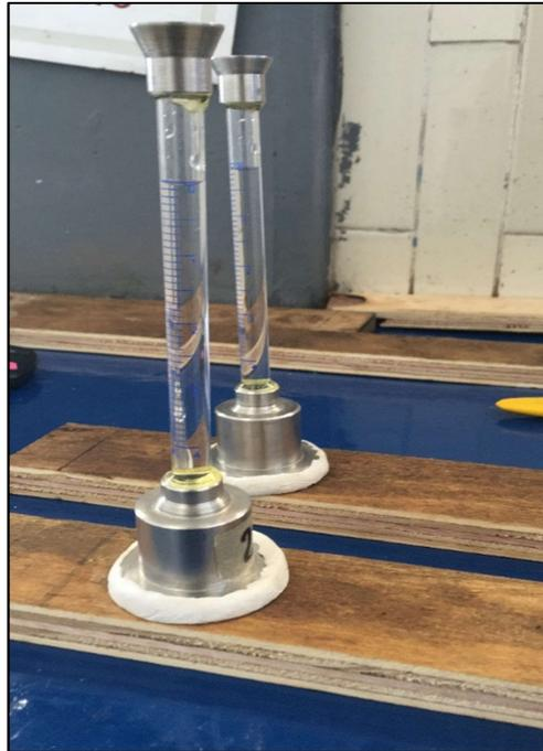
Figura 9. Ensayo de permeabilidad con tubo de Karsten en probeta de 770 x 50 mm de madera contrachapada.
