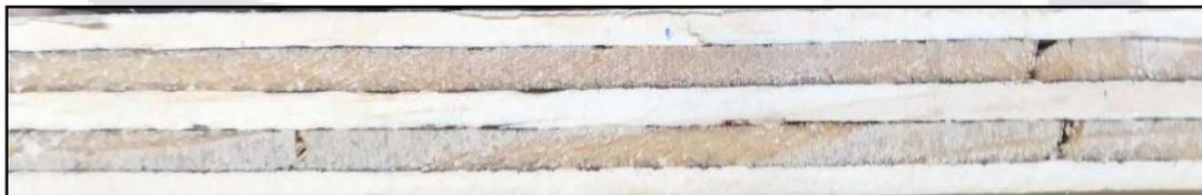
Figura 27. Corte transversal de una hoja de *triplay* donde se observan las cinco chapas que lo conforman unidas por el adhesivo impermeable de color negro entre cada chapa.
