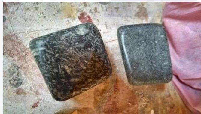
Figura 31 Piedras importadas de Marruecos utilizadas para el pulido y comprimido de la muestra.
