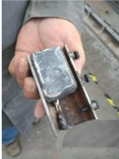
Figura 41 Piedra fijada a placa metálica
