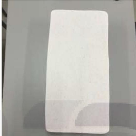
Figura 21 Probeta con la segunda capa de tadelakt aplicada y pulida con piedra de granito.
