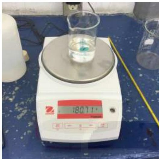
Figura 11 Determinación de la cantidad de agua destilada con la utilización de la báscula.
