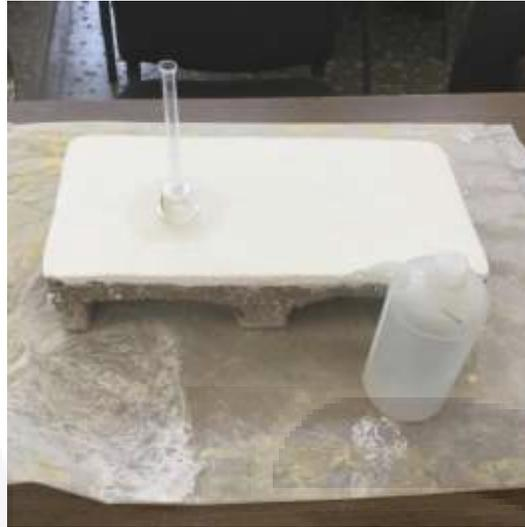
Figura 22 Ensayo con tubo de Karsten en una de las probetas.
