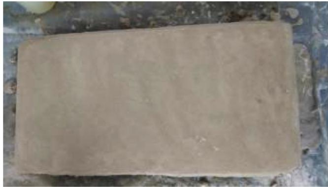
Figura 38 Segunda capa aplicada sobre una de las probetas.
