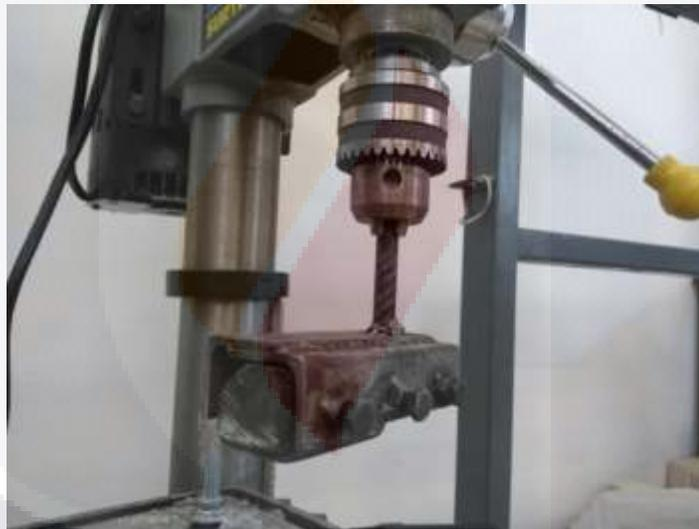
Figura 42 Fijación de la piedra a la broca del equipo
