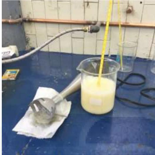
.Figura 15 Mezcla con batidora eléctrica de la solución de hidróxido de potasio (KOH) y agua destilada con el aceite de oliva virgen.
