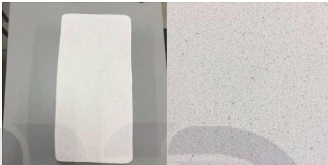
Figura 27 Prueba piloto. En la fotografía del lado derecho se observa que el grano del agregado tiene gran presencia visual en el acabado.
