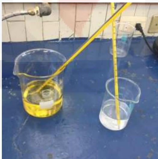
Figura 14 Medición de la temperatura con termómetro de la solución de hidróxido de potasio (KOH) con agua destilada y del aceite de oliva virgen.
