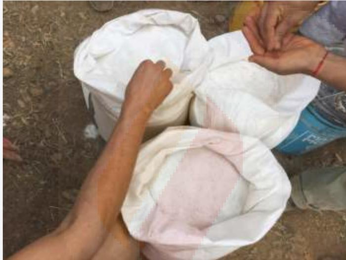
Figura 18 Agregados de distintos grosores incorporados a la mezcla: marmolina y blanco de España.
