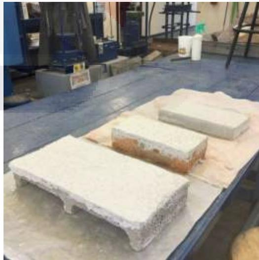
Figura 34 Repellado base cal-arena aplicado en probeta de block de concreto, tabique y pieza de concreto.
