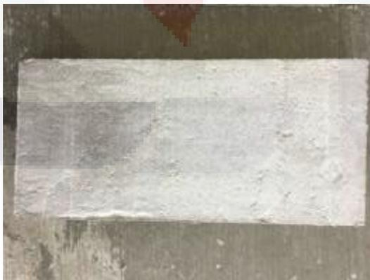
Figura 8 Pieza de concreto con acabado cerrado con llana de acero.
