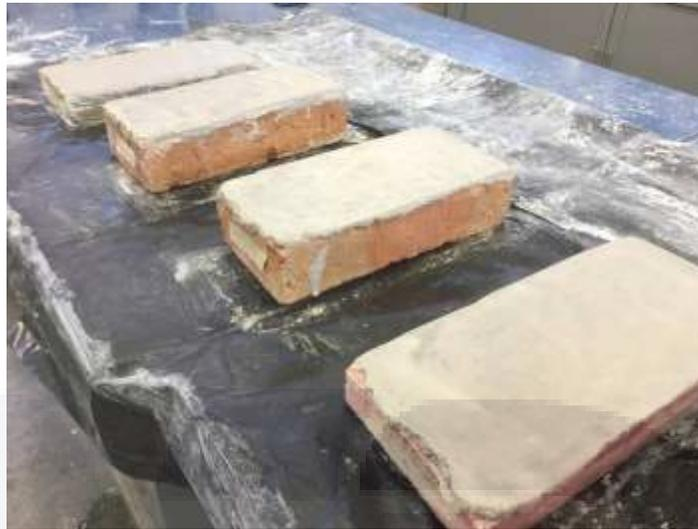
Figura 39 Ejemplos de probetas con el tadelakt terminado.
