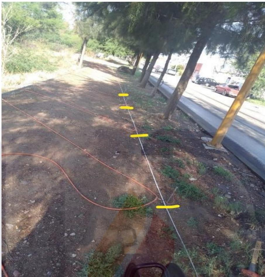
Figura 4.4. Ejemplo de la colocación de los electrodos para el levantamiento de un perfil en campo. Los electrodos están colocados junto a los segmentos amarillos para fácil distinción. Los electrodos se observan conectados, clavados en el terreno y a la separación requerida entre ellos.
