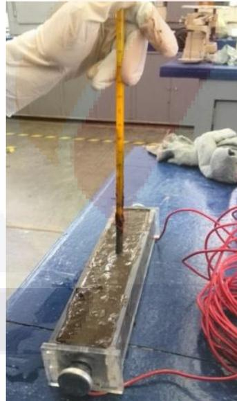
Figura 4.6.- La prueba prueba de box-soil, se observa la caja de acrílico con la muestra de suelo en su interior, además en ese preciso momento se está tomando la temperatura de la muestra previo a determinar la resistencia.
