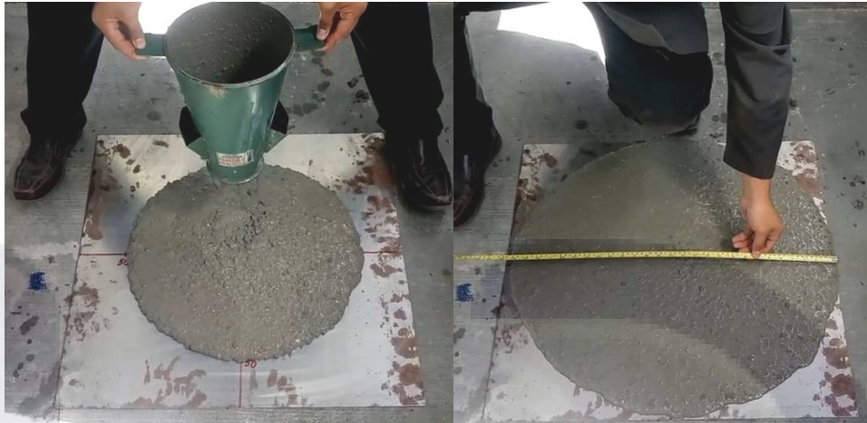
Figura 11 Prueba de flujo de revenimiento.
