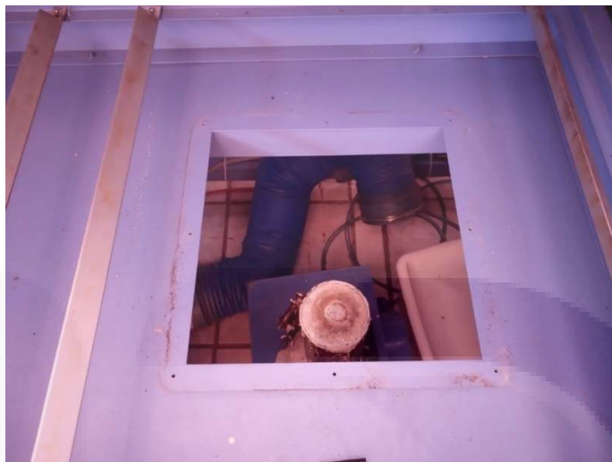
Figura 30 Muestra de concreto auto-compactable después del proceso de radiación visto desde la parte superior del sistema.
