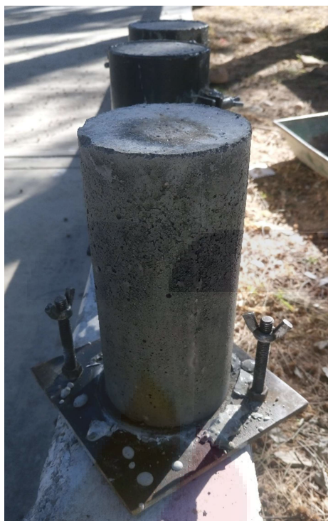
Figura 34 Descimbrado de cilindro de concreto auto-compactable irradiado a una potencia de 6.5 Watts.
