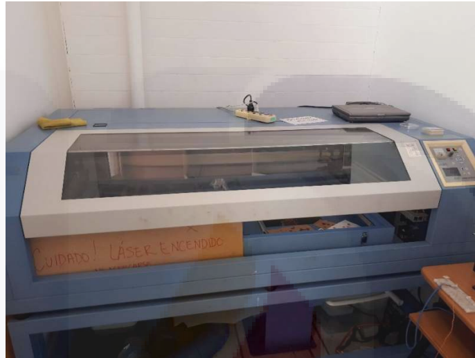
Figura 28 Láser CO2 utilizado para irradiar las muestras de concreto auto-compactable.
