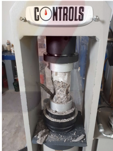
Figura 13 Fotografía de cilindro inmediatamente después de la falla en compresión.
