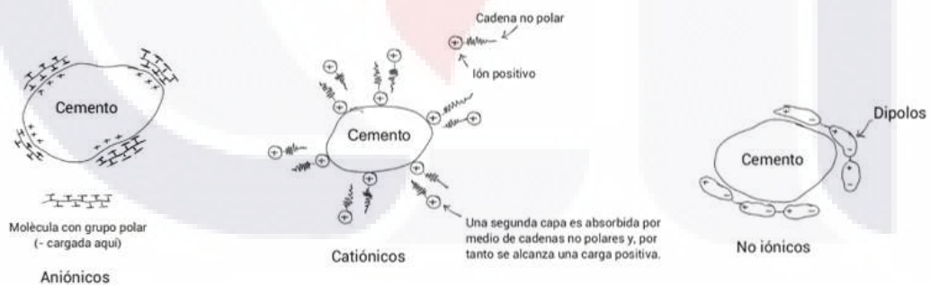
Figura 1 Funcionamiento de superplastificantes (Modificado de Pierre-Claude, 2008).
